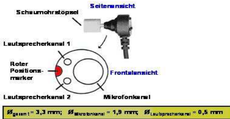
Abbildung 9: Schematische Darstellung des Sondaufbaus (modifiziert nach Müller, 2002, Seite 26).
