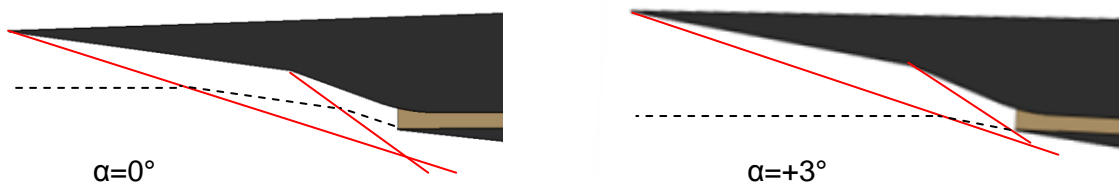
Abbildung 63: Verdichtungsstoßlage am Rampeneinlauf für unterschiedliche Anstellwinkel (schematisch)
