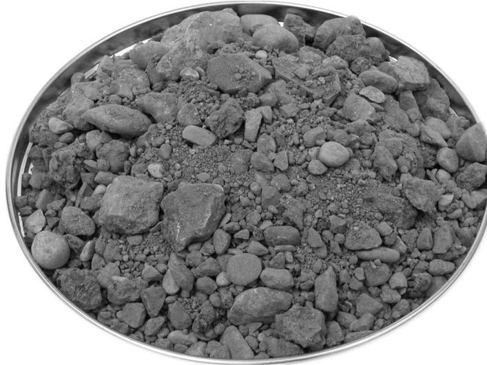
**Abbildung 7.1:** Teilprobe des Granulates S im Ausgangszustand ( $\varnothing_{\text{Blech}}$  ca. 30 cm)
