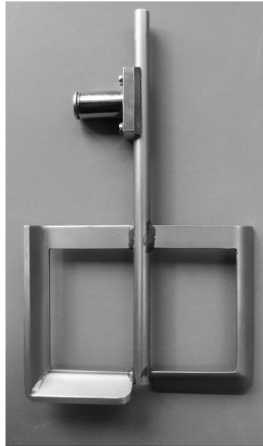
*Abbildung 5.2: Zur Untersuchung des Brechverhaltens geeignetes Messpaddel (Zementleimpaddel, nicht in Originalgröße)*
