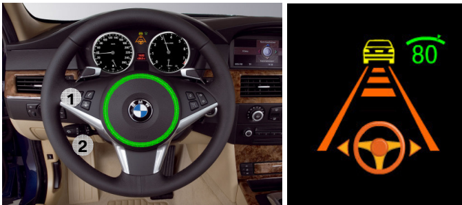
Bild 7.1: Querführungstaste (1) und Lenkstockhebel (2), Anzeigen bei aktiver Querführung
