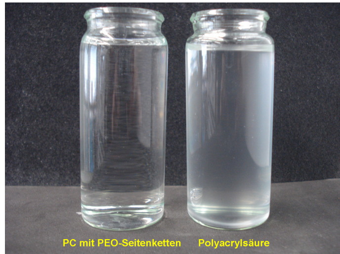
Abbildung 18: Vergleich der unterschiedlichen Löslichkeiten von Polycarboxylaten mit hydrophilen Seitenketten (links) und Polyacrylsäure (rechts) in wässriger Lösung in Gegenwart von \text{Ca}^{2+} ; (pH 12,6 ; 1g/L \text{Ca}^{2+} ; Polymerkonzentration: 20 g/L)
