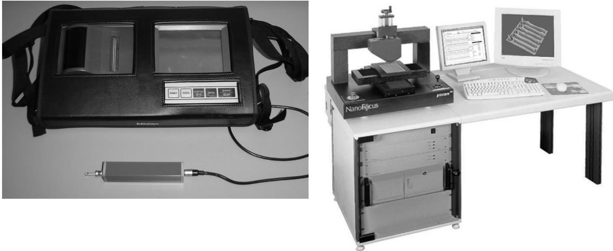
Bild 3-2 Taktiler Rauheitsmessgerät SJ-301 (Fa. Mitutoyo, links), Laserprofilometer  $\mu$ Scan mit Autofokussensor (Fa. Nanofocus, rechts)
