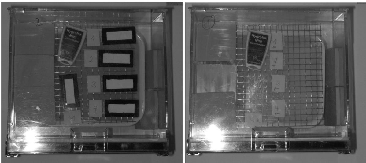
Bild 3-30 Glasplatten mit (links) und ohne (rechts) Verschmutzungsschicht (je 5 Stück), gelagert in Exsikkatoren gemeinsam mit je 5 Prüflingen aus HTV-Silikonelastomer zur Bestimmung des Hydrophobietransfers mittels LMWs durch die Luft, Lagerung bei 53% r. F., Quarzmehl SF600, Foliendicke 0,36 mm
