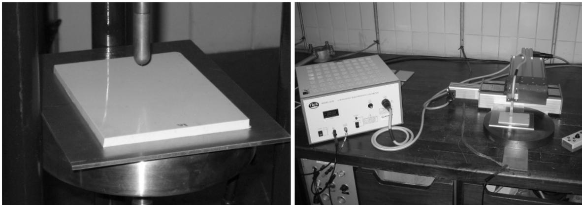
Bild 3-41 Stab-Platte Versuchsanordnung (links) und elektrostatisches Voltmeter Trek 341-B-H-CE mit Kreuztisch (rechts)
