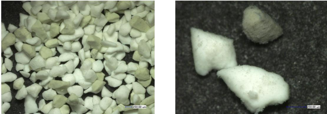
**Abbildung 4.45:** lichtmikroskopische Aufnahme der mit Biscyclopentadienylnickel beschichteten MCM-41-Partikel
