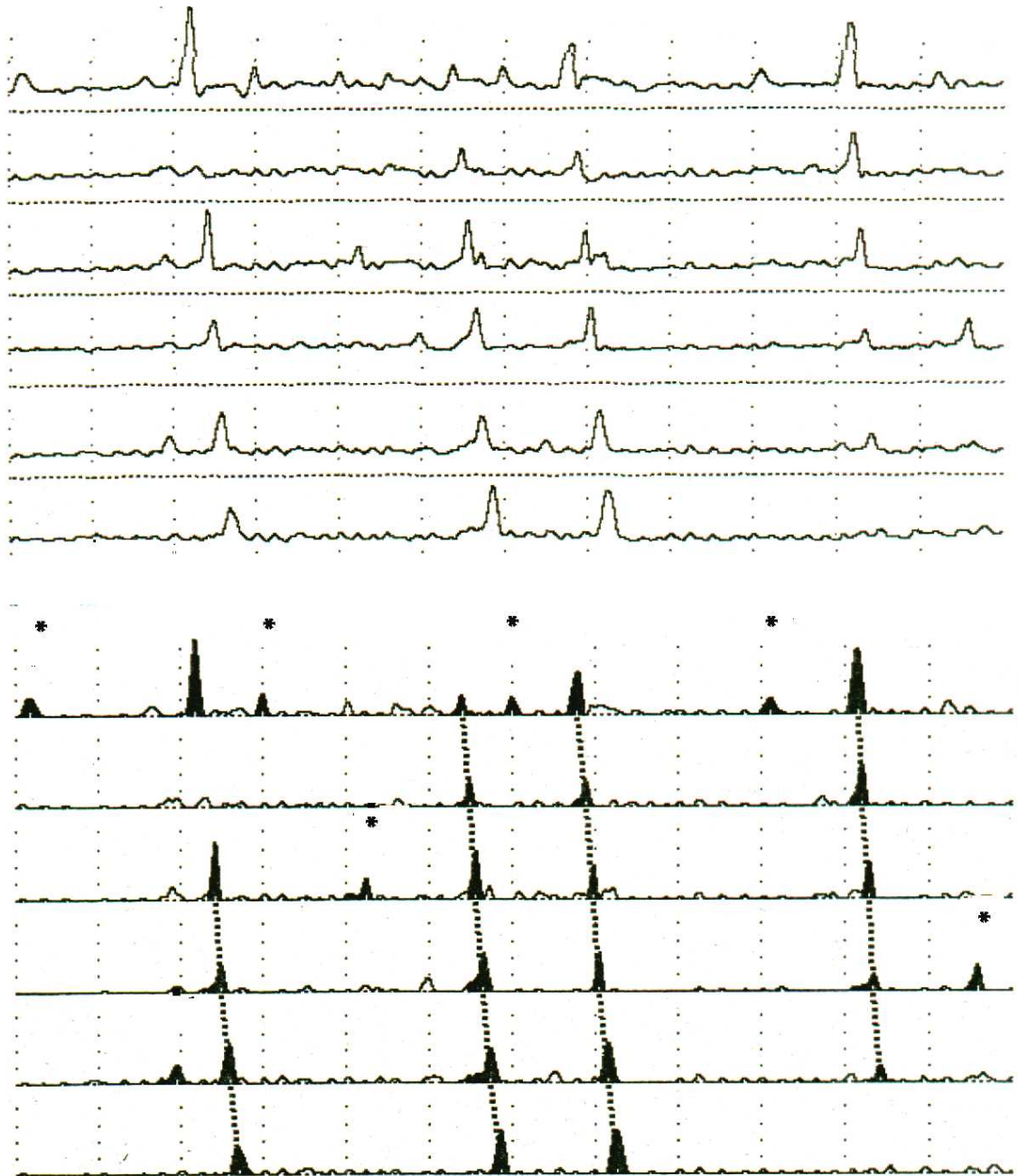
Abb. 1: Propagationserkennung durch ein Zeitfenster von 0.66 – 4.66 s (entsprechend einer Propagationsgeschwindigkeit von 0.66 – 4.50 cm/s) bei einer gesunden Versuchsperson in der Nüchternmotilität (späte Phase II). Die Druckmessung erfolgte mit 6 Sensoren im Abstand von 3 cm distal des Lig. Treitz. Der obere Teil der Abbildung zeigt die Rohdaten, der untere Teil zeigt schwarz markiert die vom Computerprogramm gewerteten und auf die Grundlinie gesetzten Kontraktionen. Mit der gestrichelten Linie sind aboral propagierte Kontraktionen verbunden, mit * markierte Kontraktionen gelten als nicht-propagiert oder stationär. Die Skalierung auf der X-Achse beträgt zwischen den gestrichelten Linien jeweils 15 s, auf der Y-Achse zwischen 2 Punkten jeweils 10 mm Hg.
