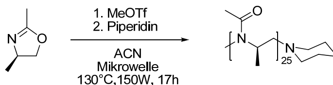
Abbildung 38: Allgemeines Reaktionsschema zur Synthese von chiralen Poly(2-oxazolin)en am Beispiel von der Polymerisation ( R )-2,4-Dimethyl-2-oxazolin.
