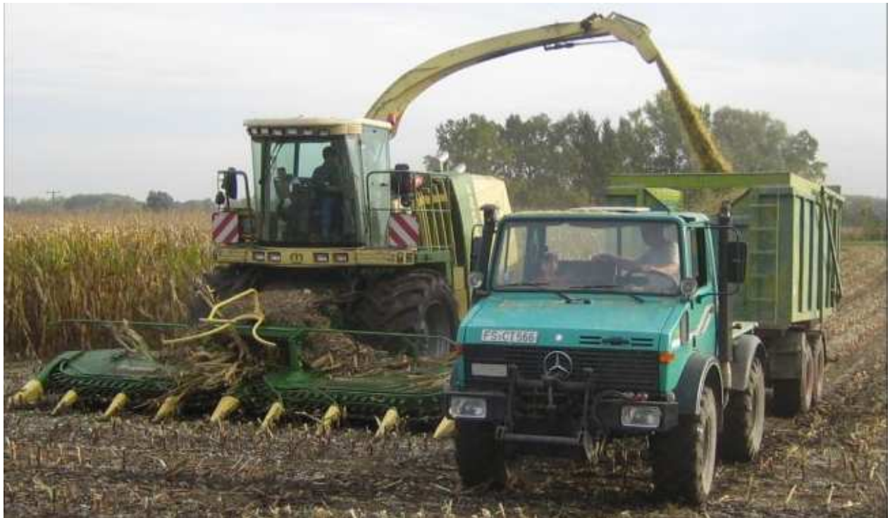
Abbildung 15: Versuchsträger Krone Big X 1000 mit easyCollect 7500 Maisgebiss im Feldeinsatz
