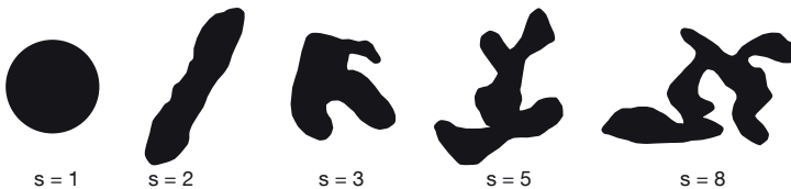
Abbildung 2.1 Schematische Poren und dazugehörige Rundheitsfaktoren nach G. Schindlbacher [SCH193, S. 383]
