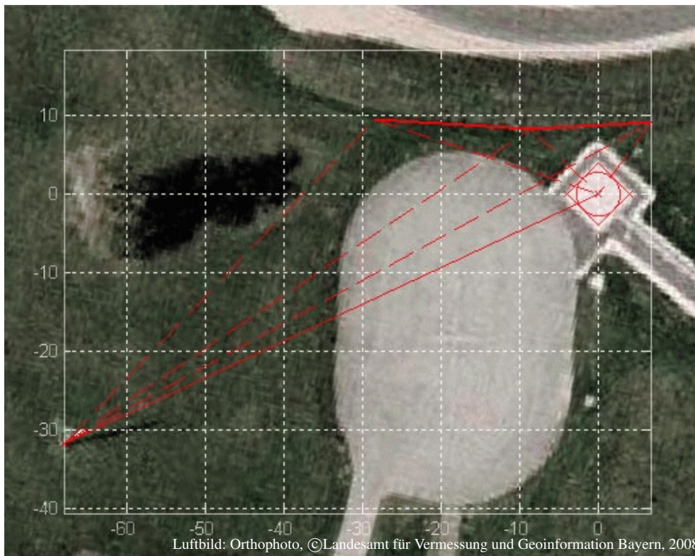
Abbildung 6.18: Messfeld mit gemessenen Reflexionspfaden
