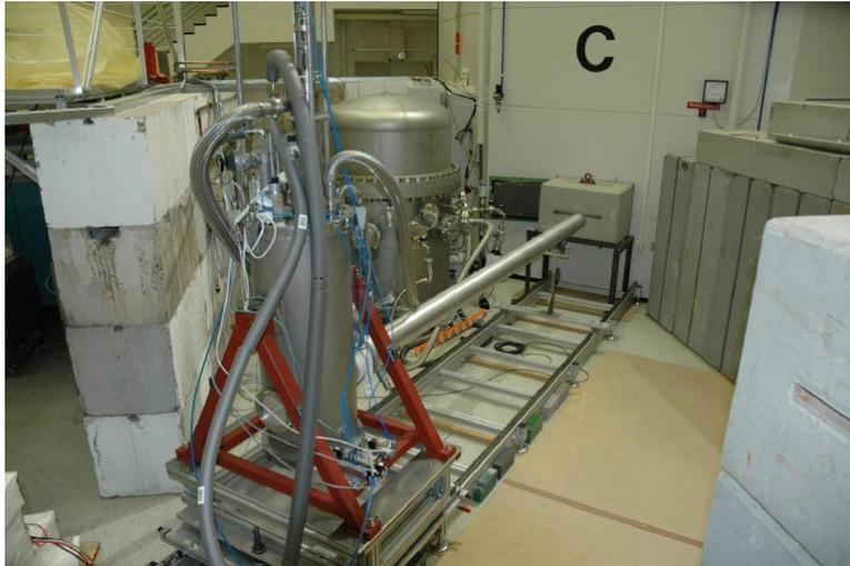
Abbildung 3.4: Der Inpile-Kryostat vor dem Einschieben in das Strahlrohr C. Im Bildhintergrund ist der Schutzgastank des Deuterium-Gassystems zu sehen.
