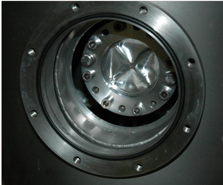
Abbildung 3.6: Blick auf das UCN-Fenster am Ende des Neutronenleiters im Kryostatenbehälter. Zur mechanischen Stabilisierung wurde eine kreuzförmige Unterstüzung angebracht.
