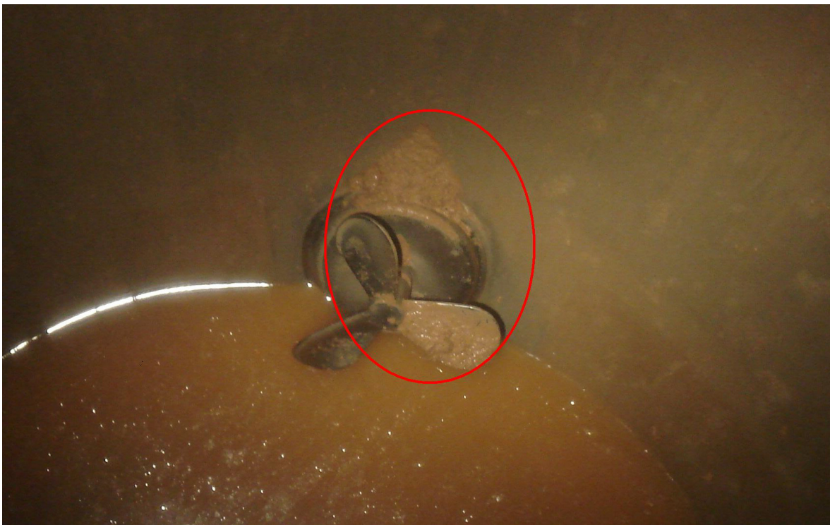
Abbildung 28: Rest einer gebildeten und an der Konuswandung heruntergerutschten Hefeschicht in einem Assimilationstank
