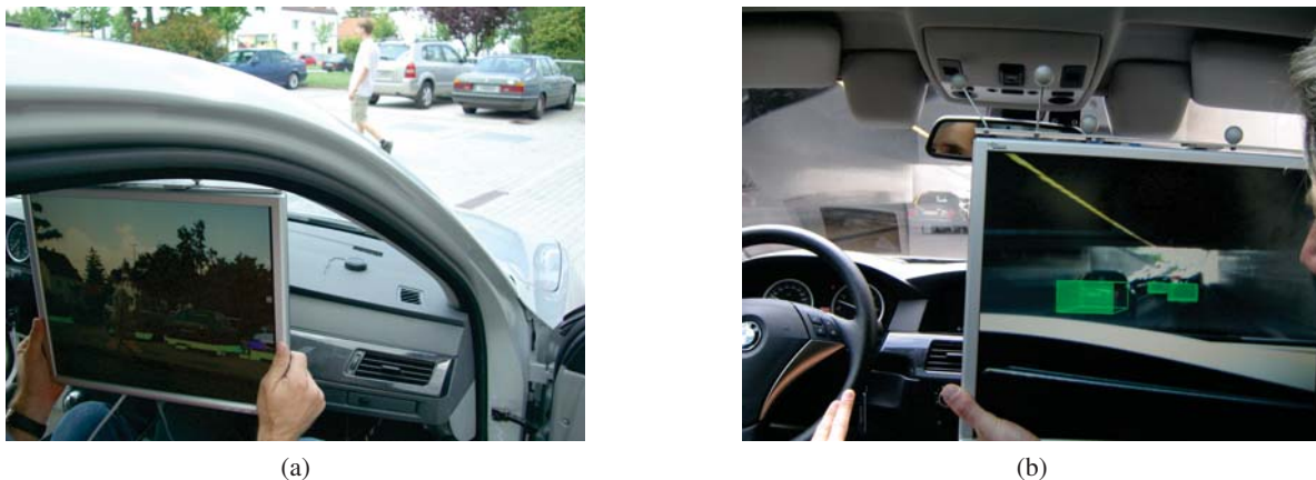
Abbildung 6.19: Im Fahrzeug können Sensor- und Objektdaten auf einem tragbaren Bildschirm dargestellt. Abbildung (a) zeigt die Daten des Laserscanners auf einem Parkplatz. Die Beine des Fußgängers werden von den Sensormesswerten überlagert. In Abbildung (b) wird das Ergebnis der Fahrumfelderfassung während der Fahrt auf dem tragbaren TFT visualisiert. Das Bild der Kamera wurde mit drei erkannten Fahrzeugen (grüne Quader) überlagert.
