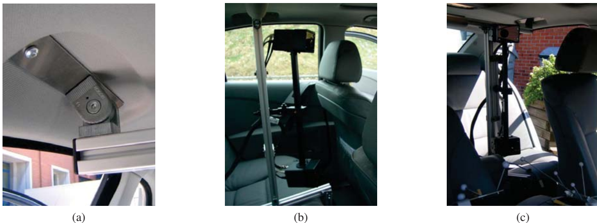
Abbildung 6.18: Installation und Ausrichtung des optischen Trackingsystems im Fahrzeug. In Abbildung (a) ist die Befestigung an den Handgriffen zu sehen. Die vertikale Verbauposition über der Rücksitzbank zwischen den Vordersitzen und die Ausrichtung der Kameras auf das Trackingvolumen (Beifahrer) ist in Abbildung (b) und (c) zu sehen.
