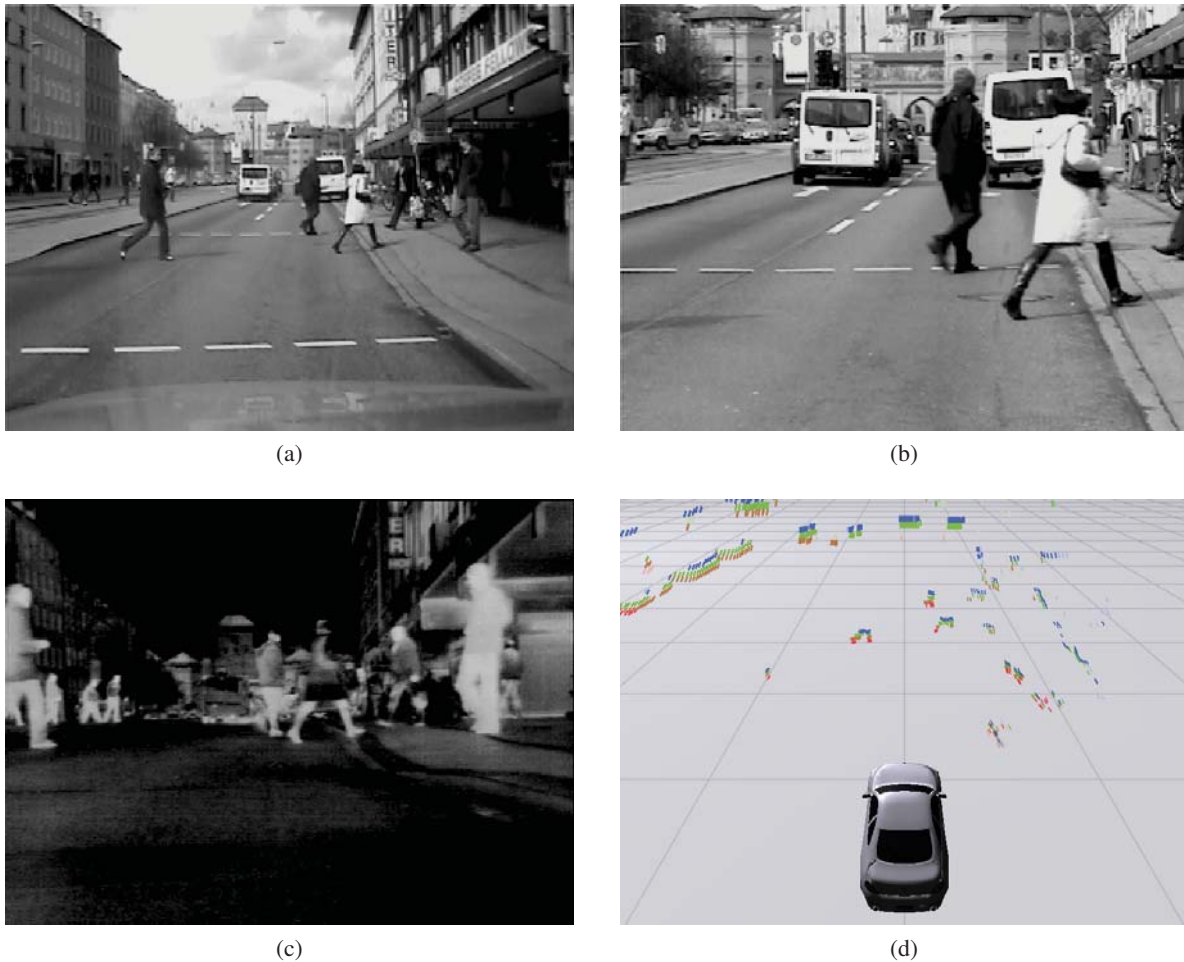
Abbildung 2.6: Momentaufnahme der Sensordaten des Versuchsfahrzeugs während einer Aufnahme-fahrt. Abbildung (a) und (b) zeigen die Bilder der beiden Videokameras mit Normal- bzw. mit Teleobjektiv. In Abbildung (c) wird das Bild der Wärmebildkamera dargestellt. Abbildung (d) zeigt die Daten des verbauten 4-Ebenen Laserscanners in einer virtuellen Umgebungsdarstellung.
