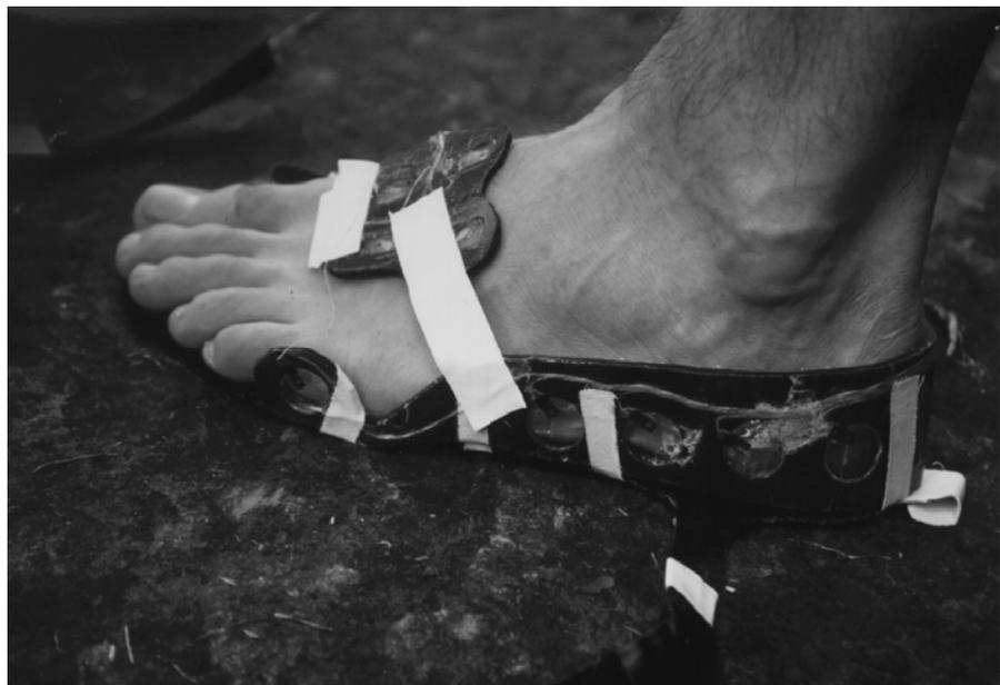
*Abb. 2, die Druckverteilungs-Mess-Socke. Im Spann- und Ristteil der Mess-Socke sind die integrierten transparenten Hydrozellen mit den eigentlichen Drucksensoren zu erkennen.*
