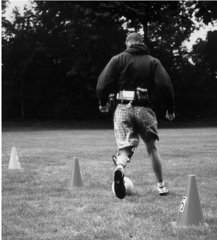
Abb. 3, die Druckverteilungs-Mess-Socke im Einsatz. An einem Gürtel trägt die Versuchsperson den mobilen Messcontroller (Datenlogger). Im Datenlogger ist links eine Speicherkarte zur Datenaufnahme eingesteckt. Unten sind Anschlusskabel der Mess-Socke und eine Antenne zur Funkauslösung zu sehen.
