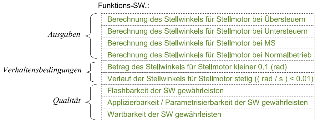
Abb. 2.6: Beispiel einer Anforderungszuweisung zur Komponente Funktions-SW.
