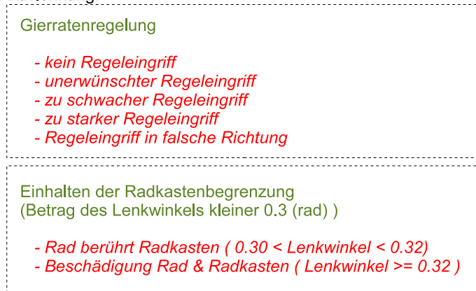
Abb. 2.9: Beispiel einer Fehlerzuweisung
