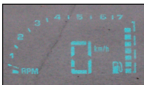
Abbildung 30: Anzeige des Tankinhaltes im Modus „Rennbahn 2“ beim Head-up-Display im Chevrolet Corvette
