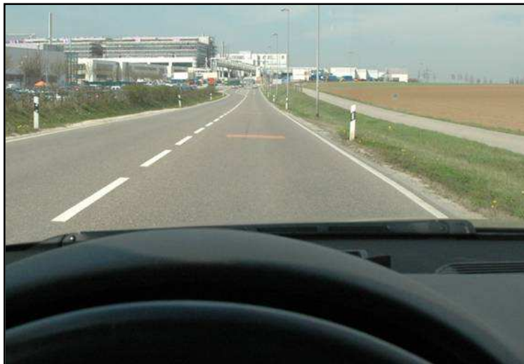
Darstellung eines Distanzbalkens in realer Fahrsituation
