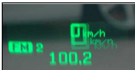
Abbildung 24: Anzeigen im Head-up-Display des Cadillac XLR
