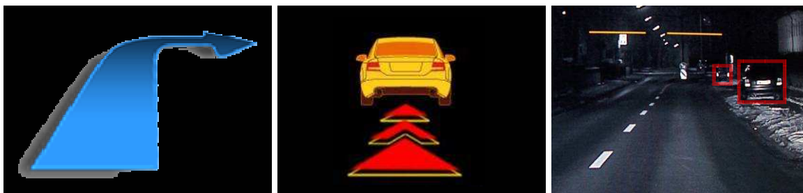
Abbildung 41: Monokulare Tiefenkriterien bei Anzeigen im Head-up-Display
