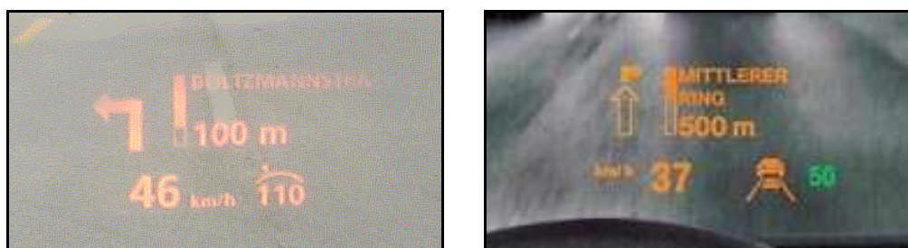
Abbildung 29: GRA- und ACC-Anzeige im Head-up-Display in der 5er- und 6er-Reihe von BMW
