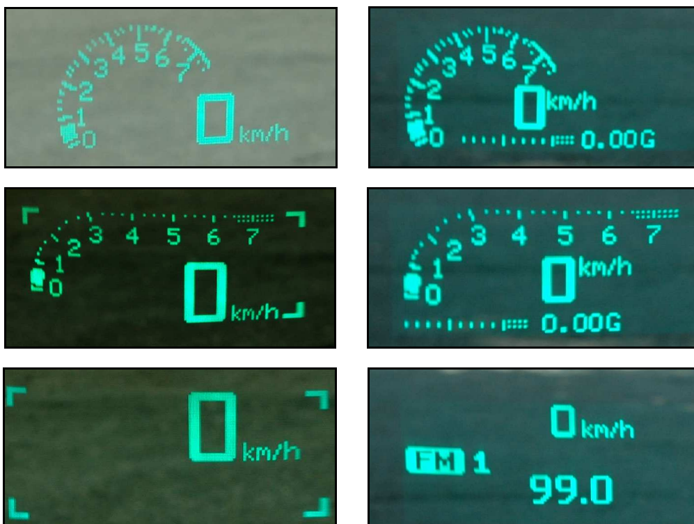
Abbildung 23: Anzeigen im Head-up-Display der Corvette von Chevrolet (Modell C6): Modus „Rennbahn 1“ (oben), Modus „Rennbahn 2“ (mittig), Modus „Strasse“ (unten)
