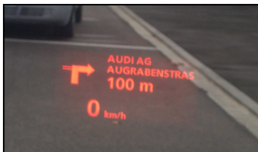
Abbildung 6: Problematik eines niedrigen Kontrasts im virtuellen Bild
