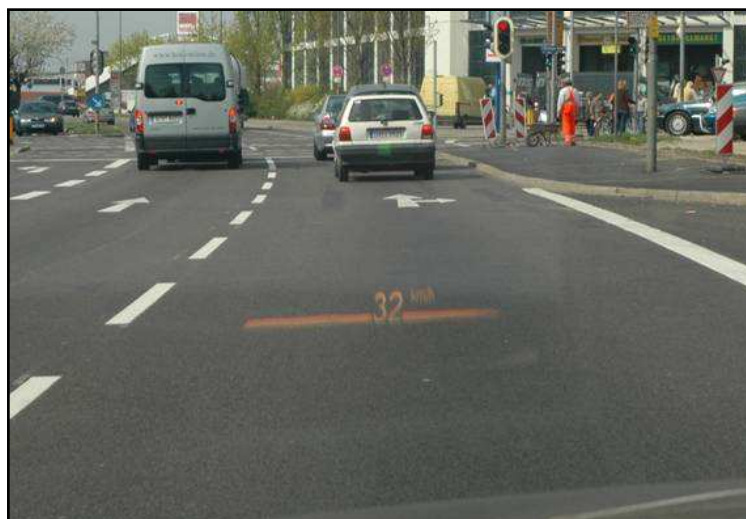
Darstellung eines Distanzbalkens mit überlagelter Geschwindigkeitsinformation in realer Fahrsituation
