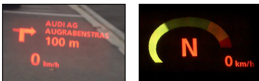
Abbildung 27: Anzeigen im Head-up-Display der 5er- und 6er-Reihe von BMW: Standardmodus (links), M-Modus (rechts)
