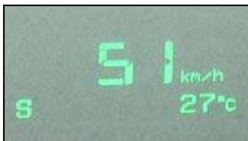
Abbildung 32: Anzeige der Himmelsrichtung und der Außentemperatur im Head-up-Display des Pontiac Grand-Prix GXP
