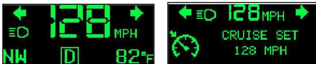
Abbildung 26: Anzeigen im Head-up-Display des Pontiac Grand-Prix
