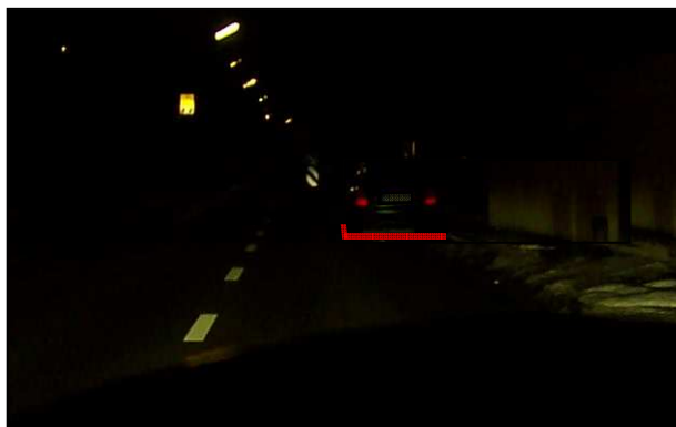
Abbildung 74: Anzeige einer Hindernismarkierung im kontaktanalogen Head-up-Display
