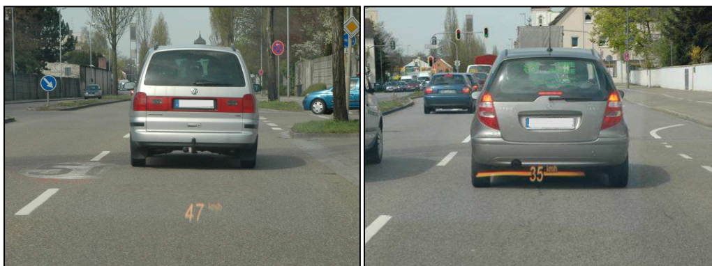
Abbildung 71: Beispiele für die Geschwindigkeitsanzeige im kontaktanalogen Head-up-Display
