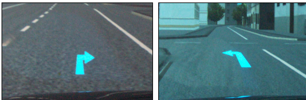
Abbildung 36: Fahrzeugfeste (links) und umweltfeste (rechts) Darstellung im HUD
