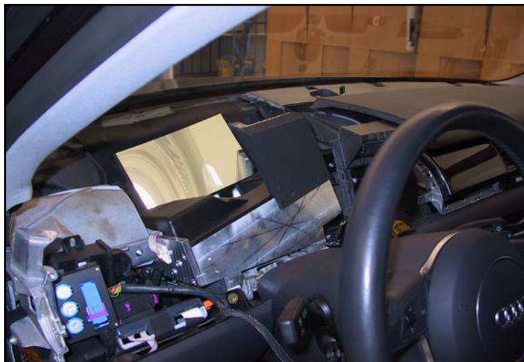
Kontaktanaloges Head-up-Display im Versuchsträger
