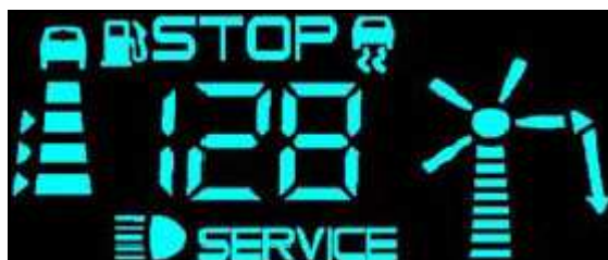
Abbildung 28: Anzeigen im Head-up-Display des Citroën C6
