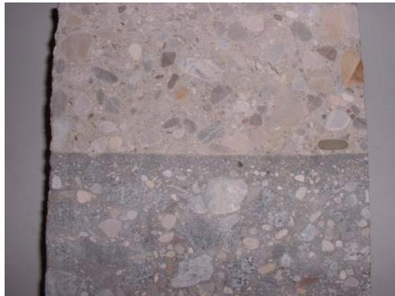
**Bild 4.25: Ausschnitt aus einer Verbundplatte (Altbeton unten). Die oberste Schicht des hochfesten Altbetons (Mischung M-5) besteht vorwiegend aus feinkörnigen Gesteinskörnern und Zementstein**
