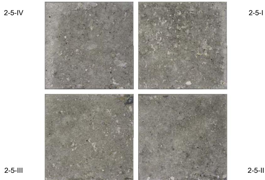
**Bild 4.47: Bruchflächen der Probekörper 2-5-I bis 2-5-IV (Neubetonseite): Es sind kaum größere Lufteinschlüsse zu erkennen. Der Neubeton enthielt kein Fließmittel (Mischung M-6)**
