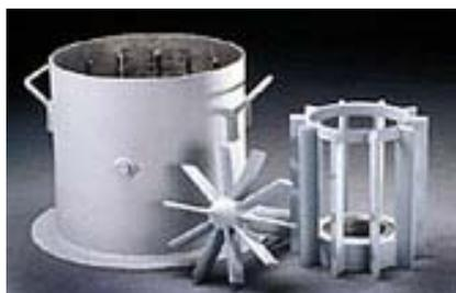
Zubehörteile: Topf mit Rippen an der Innenseite (= äußerer Zylinder); Innenzylinder bestehend aus Rippen (dieser Aufbau soll die Ausbildung einer Scherfläche an den Mantelflächen verhindern); Flügelrad zur Reduzierung störender Einflüsse an der Unterseite des inneren Zylinders
