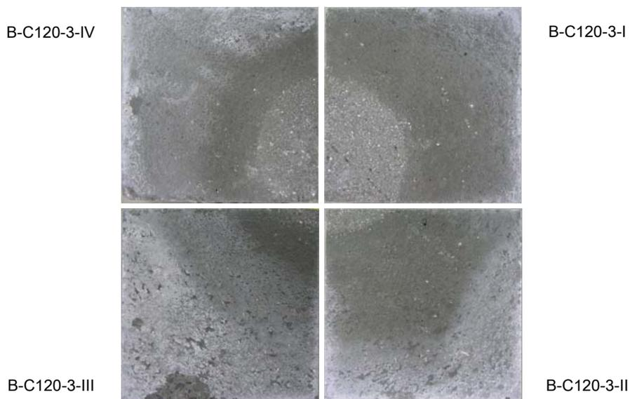
**Bild 4.26: Bruchflächen der Probekörper B-C120-3-I bis B-C120-3-IV (Altbeton: C120; Neubeton: C120; Fugenoberfläche schwach sandgestrahlt): Die Farbunterschiede deuten auf Verbundschädigungen hin, die während der 28-tägigen Lagerung der Verbundplatte auftraten. Weitgehend ungeschädigt blieb nur ein kleiner Bereich in der Plattenmitte**
