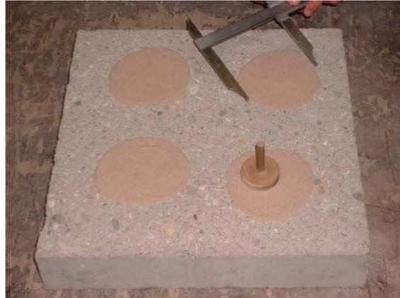
**Bild 4.4: Anwendung des Sandflächenverfahrens zur Bestimmung der mittleren Rautiefe  $R_f$  der Altbetonoberflächen**
