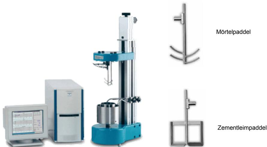
**Bild 4.53: Verwendeter Viskomat und eingesetzte Paddel [142]**
