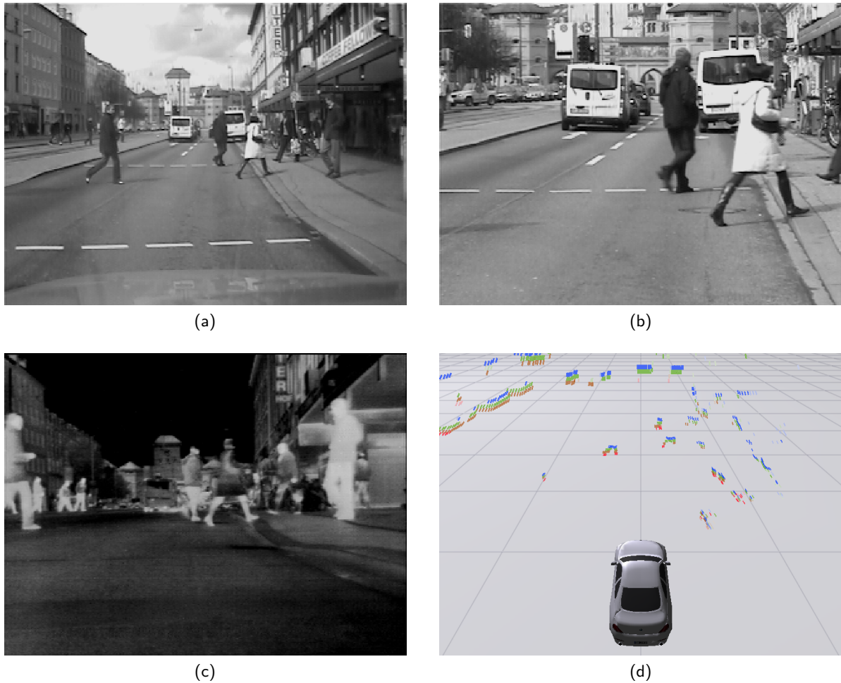
Abbildung 2.6: Momentaufnahme der Sensordaten des Versuchsfahrzeugs während einer Aufnahme. Abbildung (a) und (b) zeigen die Bilder der beiden Videokameras mit Normal- bzw. mit Teleobjektiv. In Abbildung (c) wird das Bild der Wärmebildkamera dargestellt. Abbildung (d) zeigt die Daten des verbauten 4-Ebenen Laserscanners in einer virtuellen Umgebungsdarstellung.
