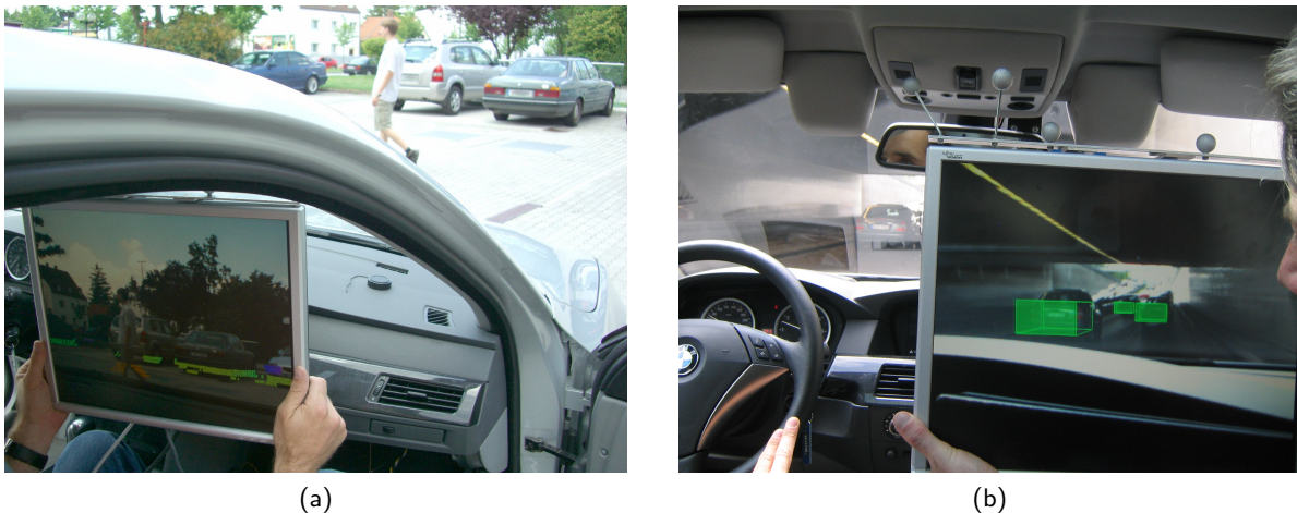
Abbildung 7.19: Im Fahrzeug können Sensor- und Objektdaten auf einem tragbaren Bildschirm dargestellt. Abbildung (a) zeigt die Daten des Laserscanners auf einem Parkplatz. Die Beine des Fußgängers werden von den Sensormesswerten überlagert. In Abbildung (b) wird das Ergebnis der Fahrumfelderfassung während der Fahrt auf dem tragbaren TFT visualisiert. Das Bild der Kamera wurde mit drei erkannten Fahrzeugen (grüne Quader) überlagert.
