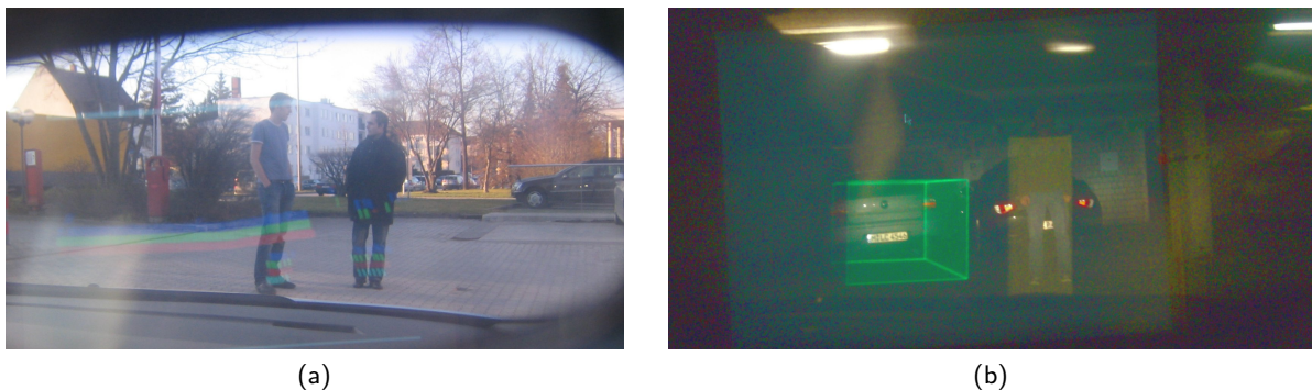
Abbildung 7.20: Im Fahrzeug werden Sensor- und Objektdaten auf einem HMD dargestellt. Abbildung (a) zeigt die Daten des Laserscanners auf einem Parkplatz. Die Beine der Fußgänger werden von den Messwerten überlagert. Um einen guten Kontrast zu erreichen, wurde in Abbildung (b) das Ergebnis der Fahrumfelderfassung in einer Tiefgarage auf dem HMD visualisiert. Die Realität wird mit dem detektierten Fußgänger (gelber Zylinder) und dem erkannten Fahrzeug (grüner Quader) überlagert.
