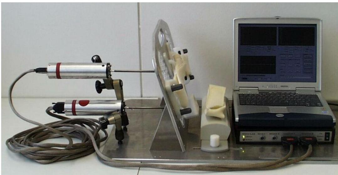
Abb. 10: Actuatorsystem mit 2 Actuatoren, Halteplatte, Steuereinheit und Slave-PC
