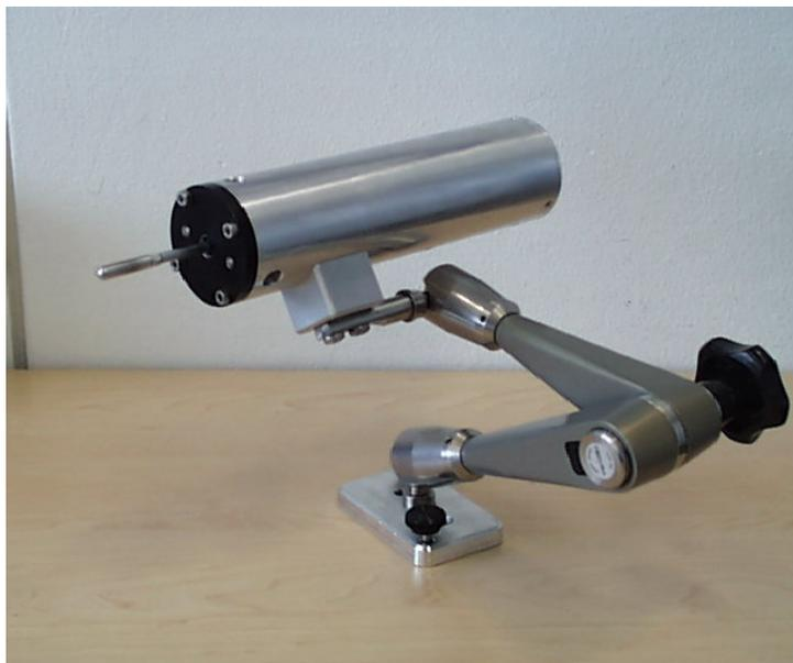
*Abb. 8: Moving Coil Actuator-System, an einem flexiblen Gelenkarm fixiert*
