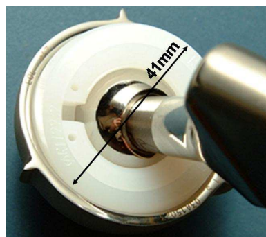
Abbildung 2.5: Abbildung des EOL-Systems, bestehend aus einem 22 mm CoCrMo-Kopf und -Einsatz, sowie einem mittels Schnapping fixierten UHMW-PE-Aufsatzes
