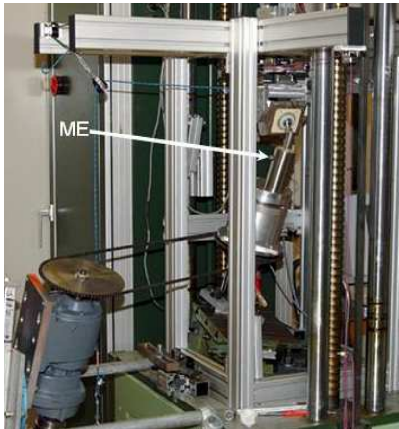
Abbildung 2.9: Darstellung des Luxationsprüfstandes in 10^\circ Extension und 15^\circ Adduktion; mit einem Pfeil gekennzeichnet ist die Messeinheit (ME), welche mittels Drehmomentsensor und Drehwinkelnehmer die Winkelbewegungen und Widerstandsmomente aufnimmt
