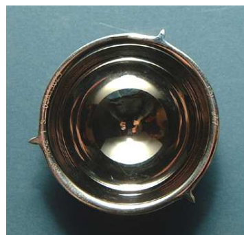
Abbildung 2.5: Abbildung des EOL-Systems, bestehend aus einem 22 mm CoCrMo-Kopf und -Einsatz, sowie einem mittels Schnapping fixierten UHMW-PE-Aufsatzes
