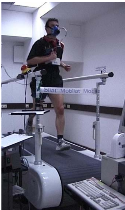
Abb. 7: Spiroergometrie auf dem Laufband
