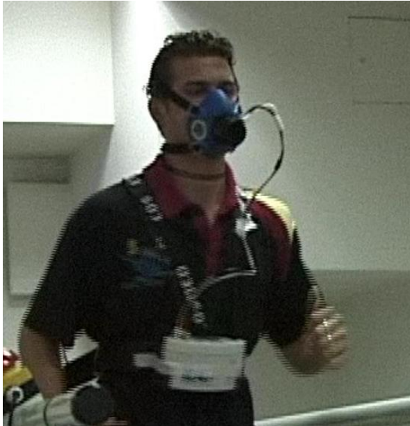
Abb. 10: Tragbare Einheit und Maske von Cosmed K4b2
