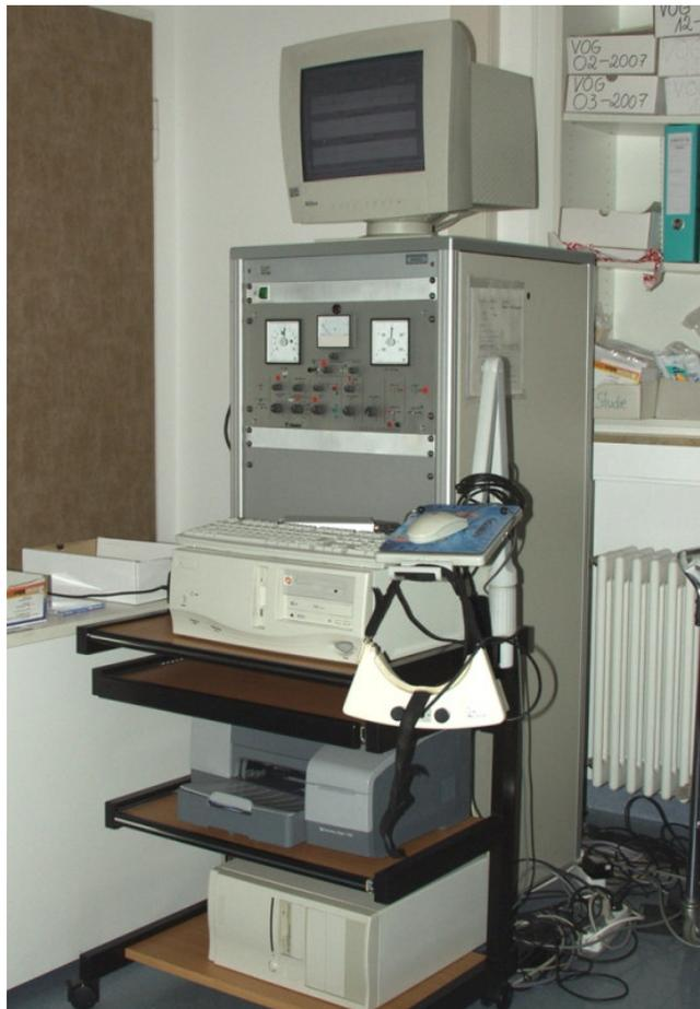
Abb.6: Videookulographiegerät (Fa.Hörniß und Zeisberg)
