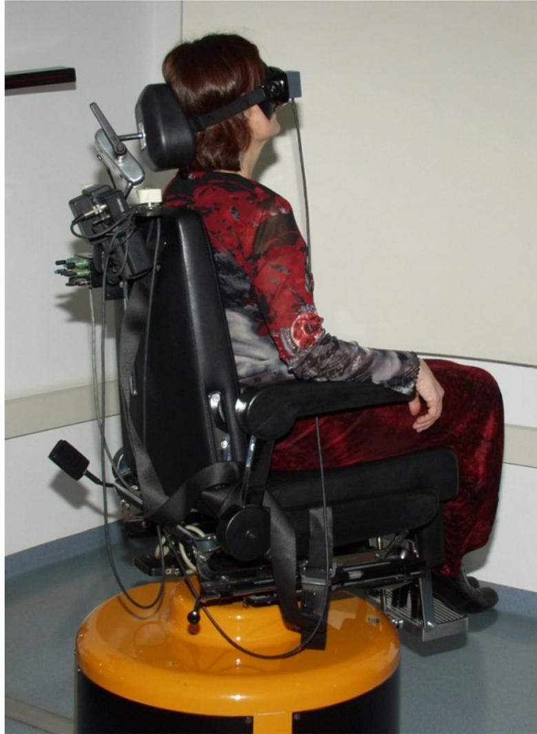
Abb.8: Patientin mit lichtausschließender Maske auf Untersuchungsstuhl zur Analyse des SPN
