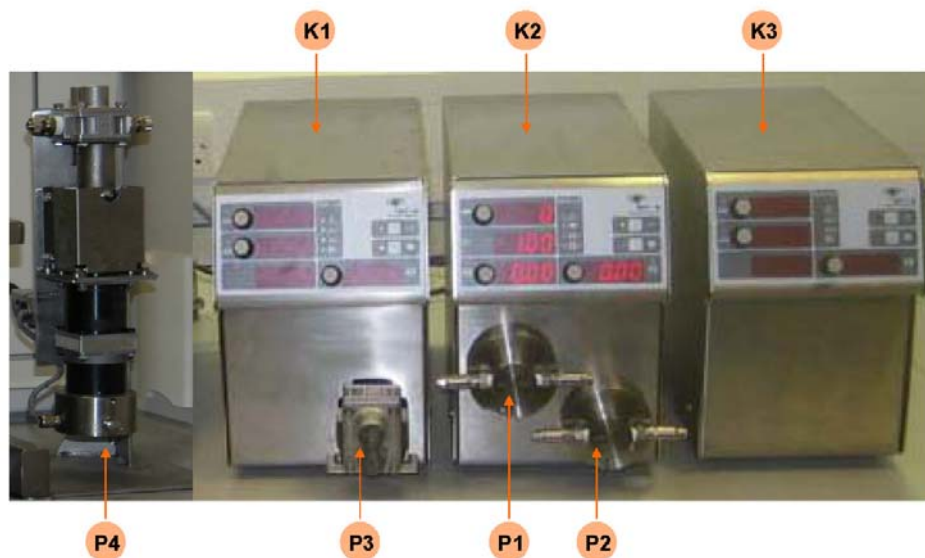
Abb. 23: Steuerungseinheiten und Pumpen für die SDR -Anlage
