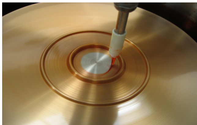
Abb. 17: Kontinuierlicher, stabiler Polyolfilm auf einer rotierenden Scheibe
