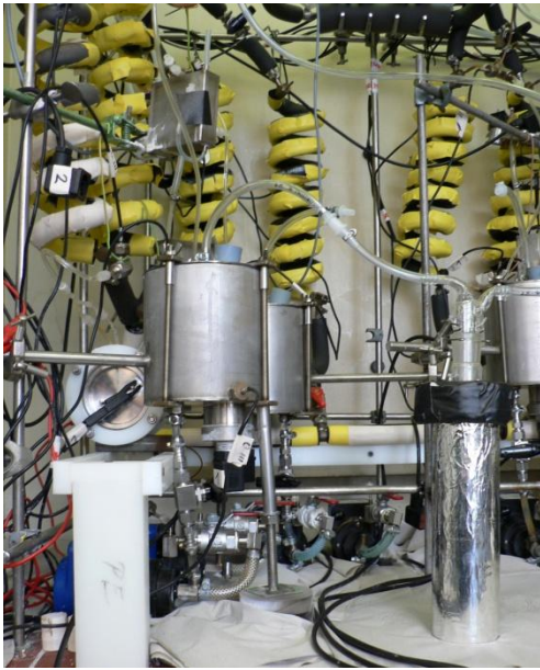
Abb. 42: Verwendete Elektrolyseanlage mit an den Vorratsbehälter angeschlossenem Abluftsystem; links: Foto; rechts: Zeichnung der Anlage; Entwicklungsstufe IV.
