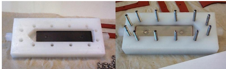
Abb. 17: Bipolare Elektrolysezelle der ersten Generation.
