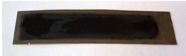
Abb. 24: Bipolare Elektrode mit schwarzen Ablagerungen auf der Kathodenseite.
