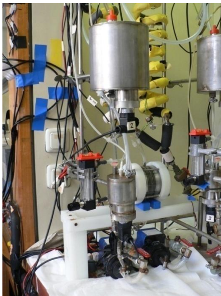
Abb. 45: Links: Elektrolysesystem der Entwicklungsstufe V; Batch und Continuous-Feed Modus möglich; Rechts: Verkleinerter Systembehälter mit Füllstandssensor.
