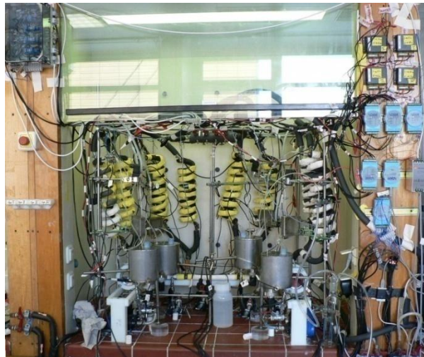
Abb. 38: Elektrolyseanlage der Entwicklungsstufe III mit Edelstahlbehältern, Füllstandssensoren und dem Prototyp eines Abluftsystems.
