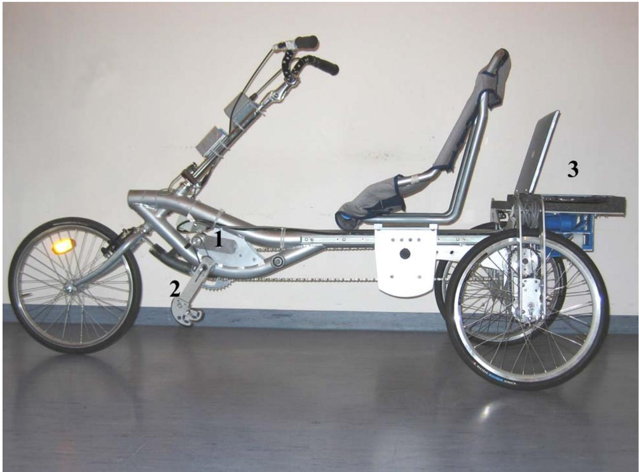
**Abbildung 5-14: Adaptiertes Dreirad für Paresepatienten; ein autarkes System mit vier Stimulationskanälen zur synchronisierten Bewegung der Oberschenkel wird mitgeführt.**
