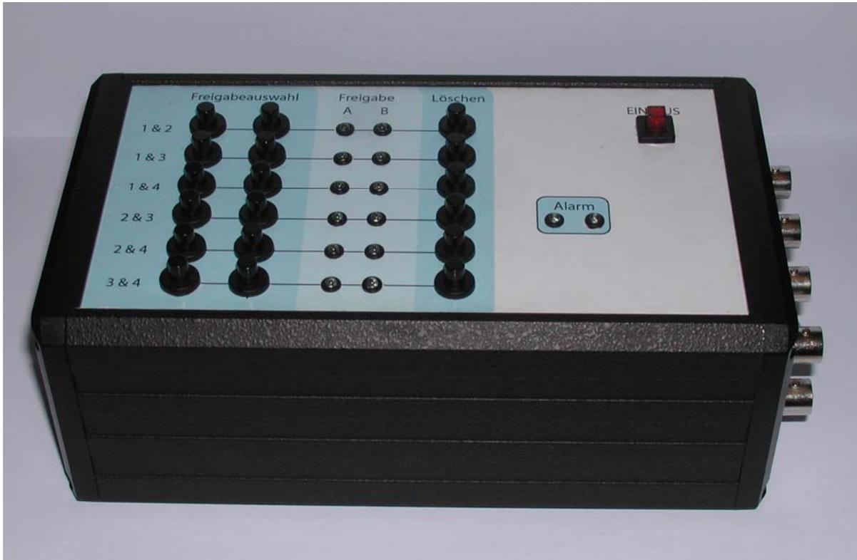
**Abbildung 5-13: Die fertige Puls-Koordinationseinheit (PKE) für das VW-Projekt. Auf der Frontplatte ist das Eingabefeld für die manuelle Freischaltung von Kanalkombinationen erkennbar.**
