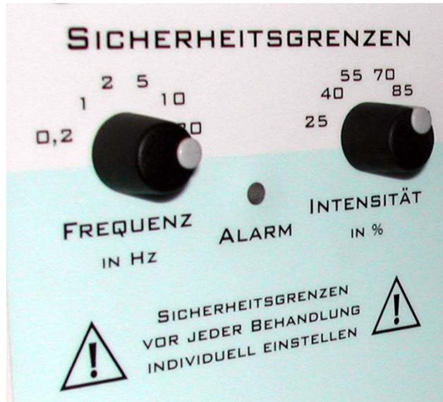
Abbildung 6-4: Einstellmöglichkeit der Outputgrenzen an der Frontplatte des Neurostimulators.
