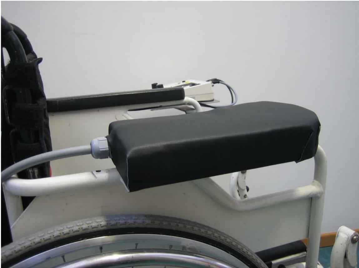
**Abbildung 5-16: Armauflage mit fest integrierter Behandlungsspule (im Vordergrund).**
