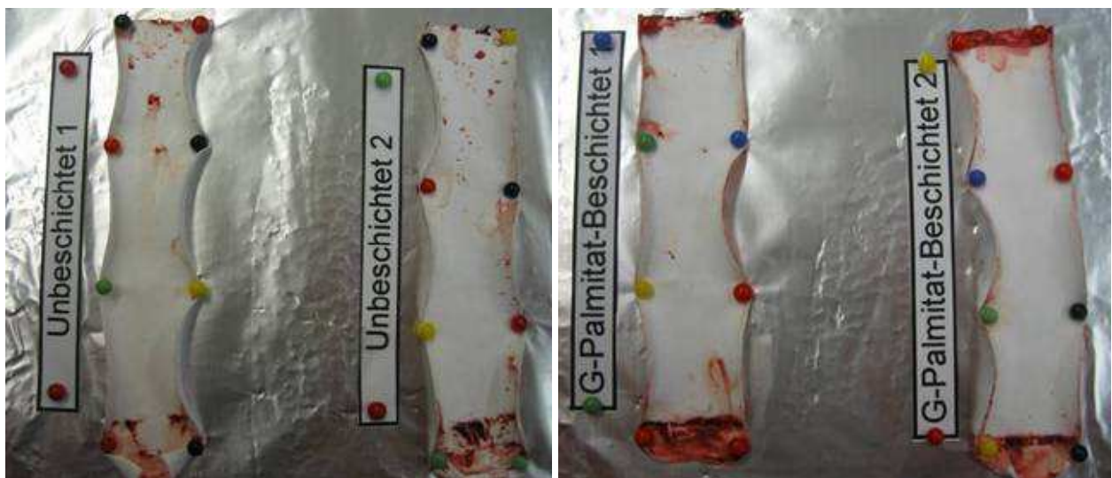
Abb. 3.14a: Innenseite verschiedener PTFE-Gefäßprothesen nach 7-minütigem Blutkontakt
