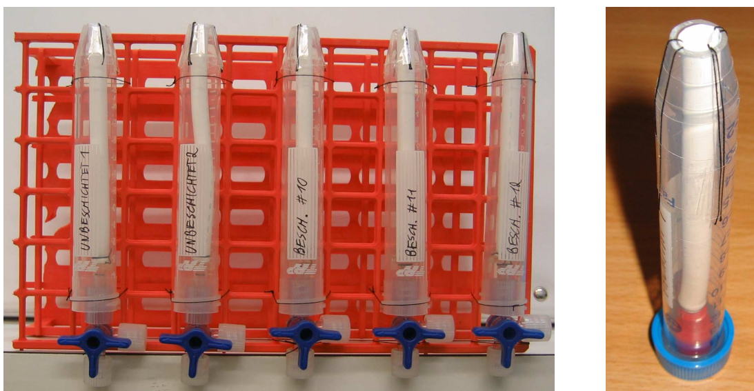
Abb. 2.1: Zur Untersuchung der Hämokompatibilität eingespannte PTFE-Gefäßprothesen
