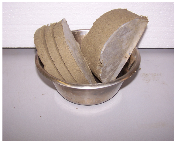
Abb. 3-14: Einzelne Schichten (Filterpapier wurde vor Bestimmung der Wassergehalte entfernt)
