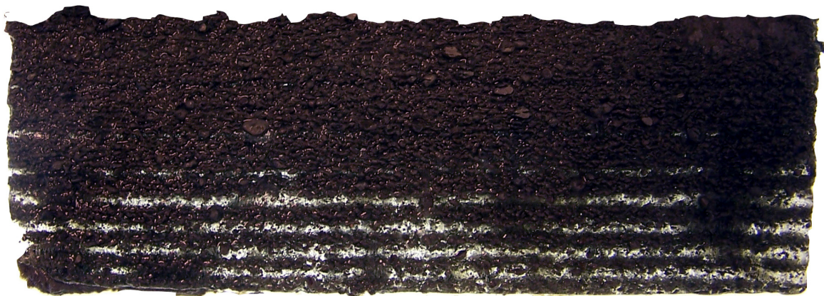
Abb. 3-28: Detailausschnitt aus dem gefrorenen Ton-Frostkörper.
