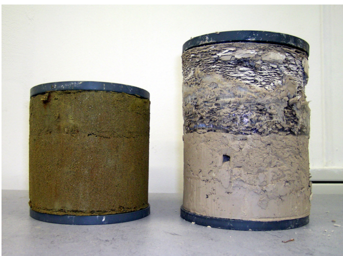
Abb. 3-20: Ausgebaute Proben: tertiärer Sand S links und Kaolin K rechts.
