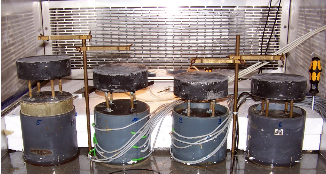
Abb. 3-26: Proben mit installierten Wärmefühlern nach dem Versuchsende
