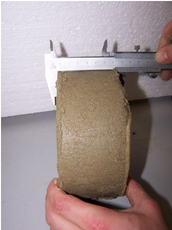
Abb. 3-11: Vermessung des Frostkörpers
