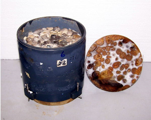
Abb. 3-8: Nullversuch mit Blick auf die Unterseite des Stempels
