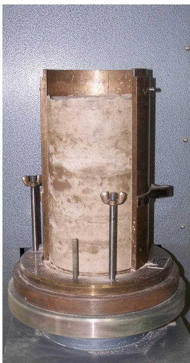
Abb. A3.2-1: Probenherstellung mit Kaolin K
