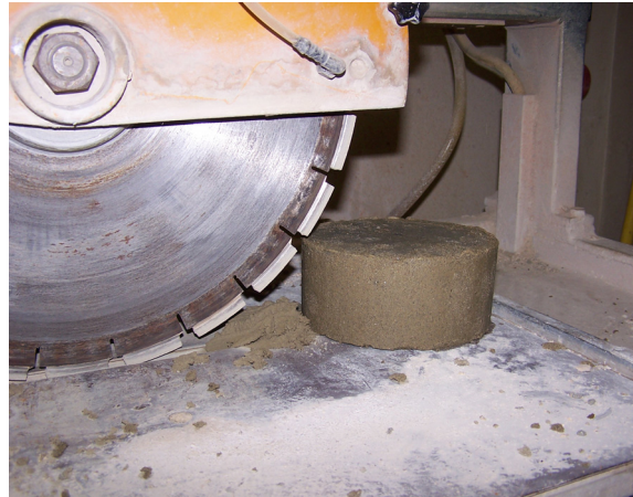
Abb. 3-12: Radialschnitt durch den Frostkörper
