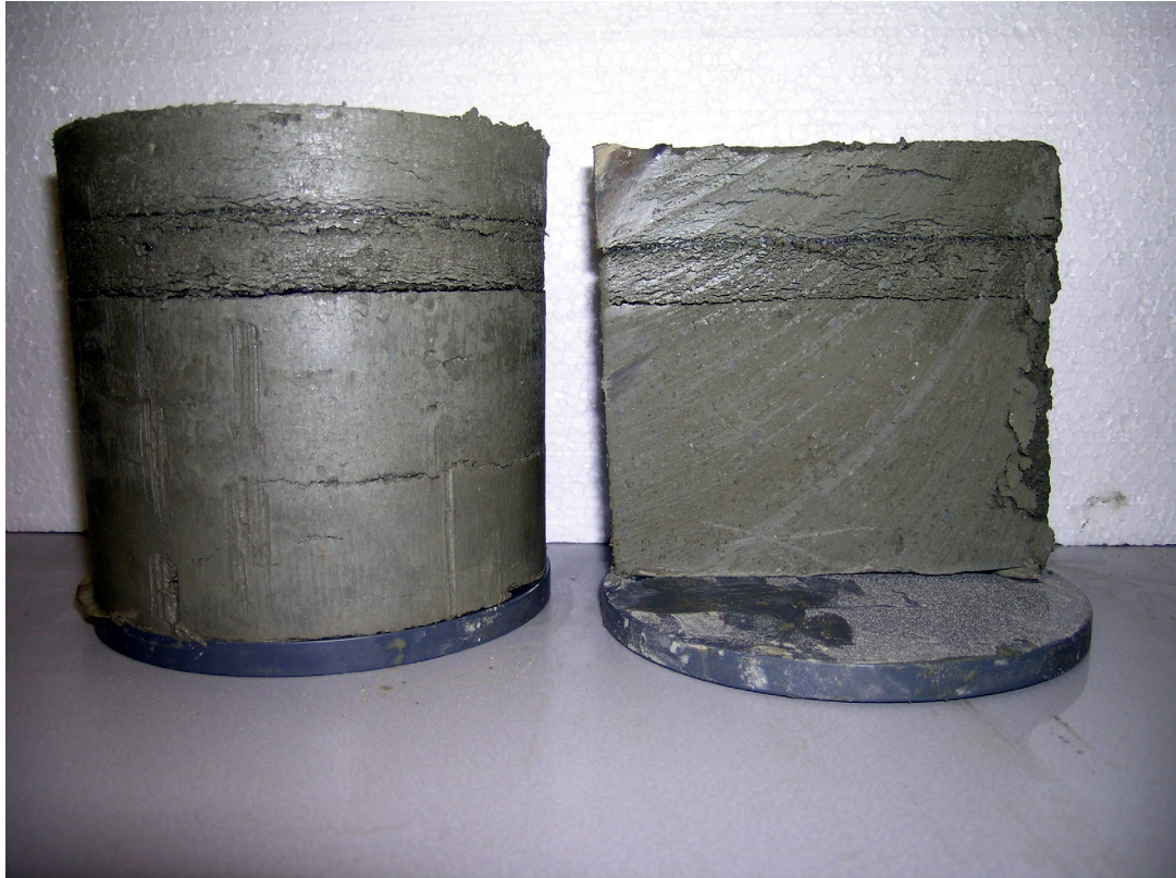
Abb. 3-31: Ansicht Probekörper 1 und Schnitt durch Probekörper 2 nach Versuchsende
