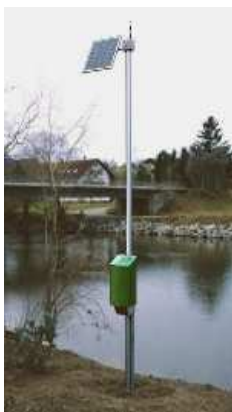
Abb.7-011: CompactStation für Wassermessungen [INTERNET 38]
