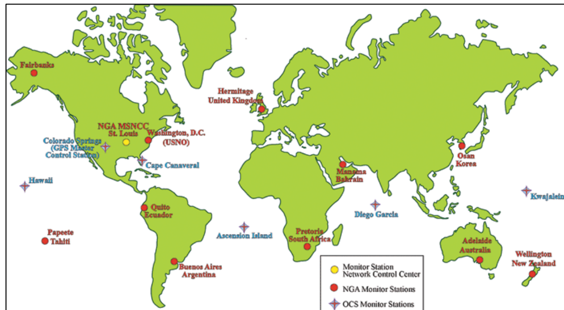
Abb.2-012: GPS-Kontrollstationen nach der Modernisierung [GLÜCKERT 2006]
