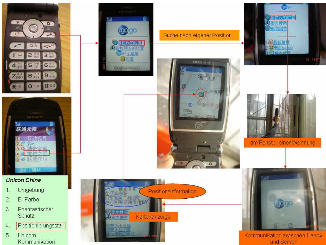
Abb.9-002: Vorgehensweise des NavigationStars von Unicom China anhand Handy KZ860 mit gpsOne-Technik
