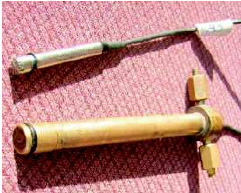
Abbildung 4.9: G.R.A.S. Mikrofon (oben) und in Halte-/Kühlzylinder eingebaut (unten)
