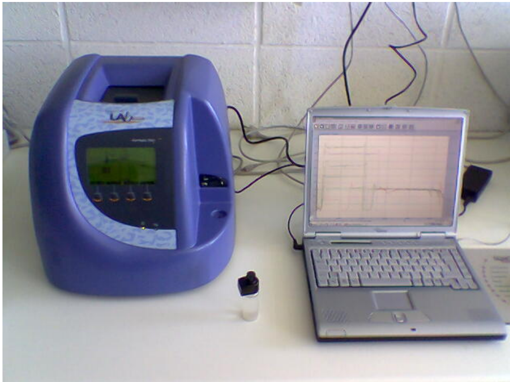
Abb. 6.2: Trübungsmessgerät Turbiscan LabExpert mit Auswertecomputer
