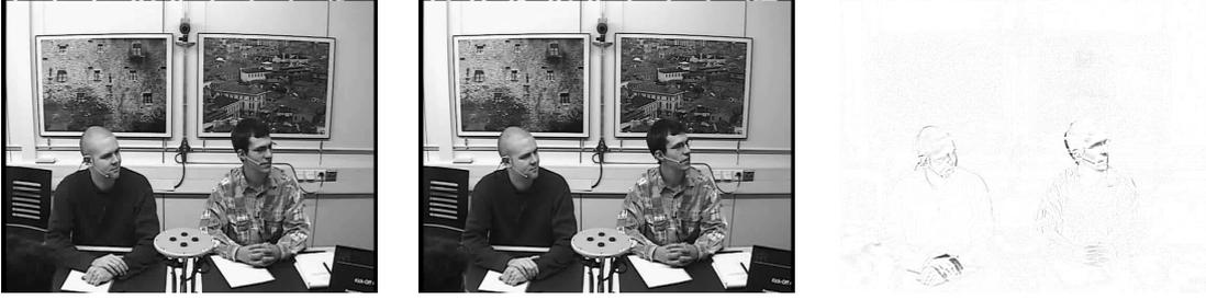
**Abbildung 5.4:** Zwei Bilder der rechten Kamera und das daraus erzeugte (ungefilterte) Differenzbild. Dieses kann als Bewegung der Personen im Besprechungsraum interpretiert werden. Zur besseren Visualisierung wurden hier zwei Bildern verwendet, die vier Sekunden auseinander liegen. Für die Erzeugung der globalen Bewegungsmerkmale wird das Differenzbild aus unmittelbar aufeinanderfolgenden Bildern berechnet.
