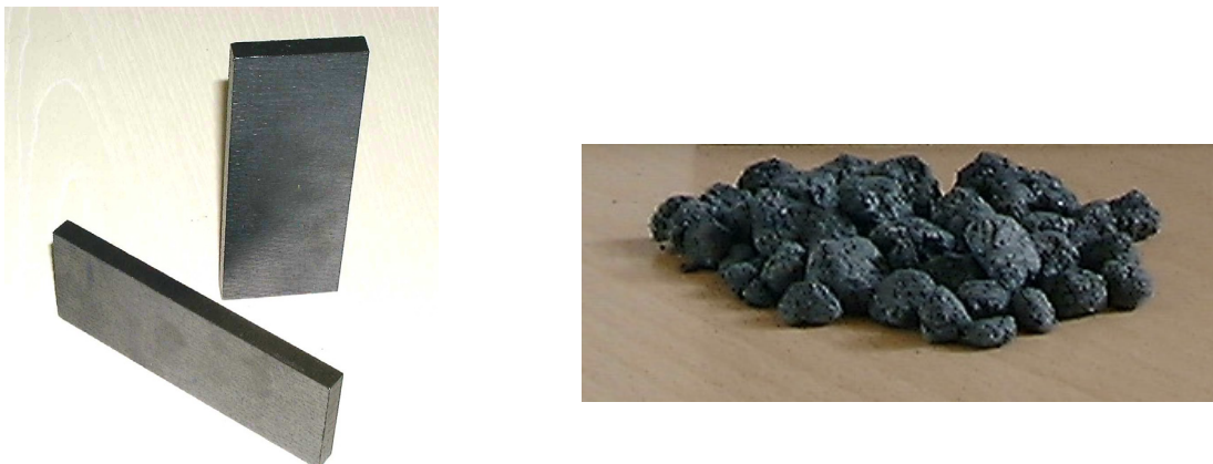
Abbildung 2-5: Von SGL TECHNOLOGIES GmbH hergestellte Paraffin-Graphitmatrix-Verbund (links) und NaOAc·3H 2 O-Graphit-Verbund-Granulat.
