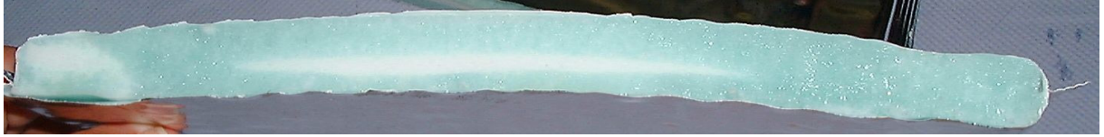
Abbildung 2-6: SP 22 (experimentell) der Rubitherm GmbH in einen Schaum eingebracht und mit einer Aluminiumverbundfolie in Plattenform verschweißt (aufgeschnitten).
