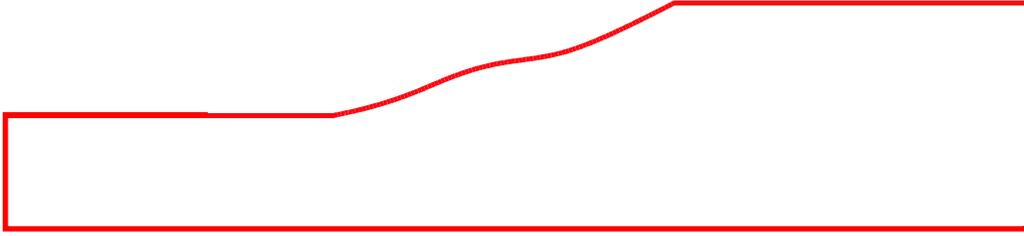
Abbildung 5.6: Mit Hooke & Jeeves auf der RSA mit fünf Design Variablen ermitteltes Optimum der Diffusorgeometrie
