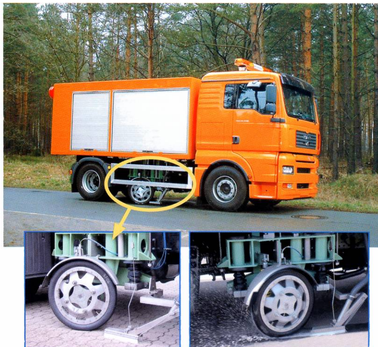
Bild A 6: oben: Messfahrzeug SKM unten: Detail des schräglaufenden Messrades
