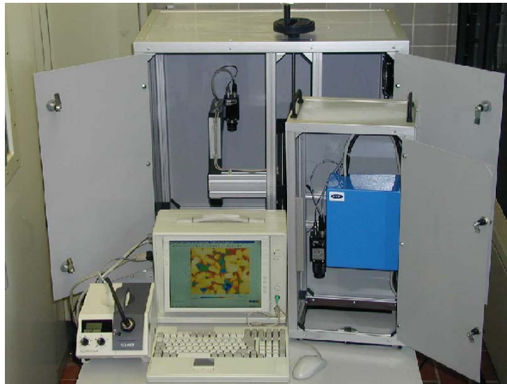
Bild A 9: Aufbau eines photooptischen Messsystems: hier das T3D Messsystem der BASt
