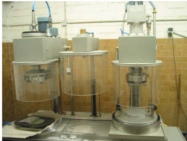
Bild A 13: Apparatur Laborgriffigkeitsmessgerät Wehner/Schulze der TU München (neue Generation)
