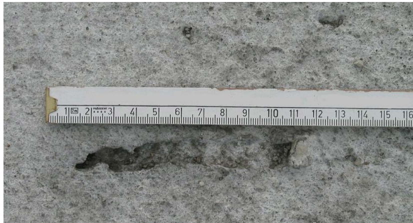
Bild 41: Detail einer Stelle, an welcher ein grobes Gesteinskorn infolge des weichen Oberflächenmörtels durch das Jutetuch aus der Matrix herausgelöst und mitgeführt wurde
