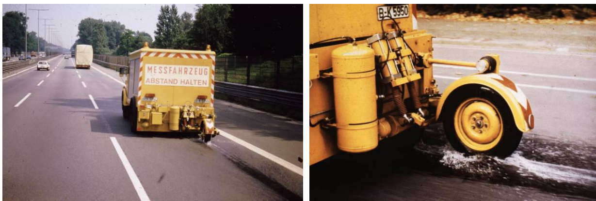
Bild A 7: links: Stuttgarter Reibungsmesser (SRM) während der Messfahrt rechts: Im Detail blockiertes Messrad
