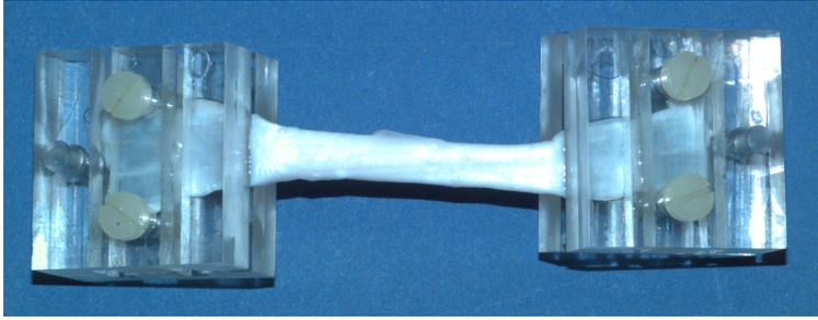
Abb. 7: Kunststoffklemmbaken für die MRT-Messung
