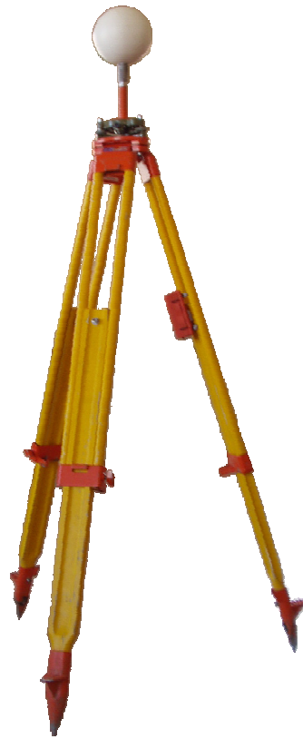
Abb. 14: Als Referenzmarke an einer Wand angebrachte Scheibe (links) und auf einem Dreibein befestigte Kugel (rechts)
