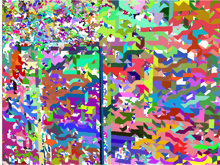
Abb. 54: Im vergrößerten Ausschnitt aus Abb. 53 ist zu erkennen, in welche kleine Segmente das Dreiecksnetz aufgeteilt wird: 99% der Segmente beinhalten weniger als 10 Dreieckselemente
