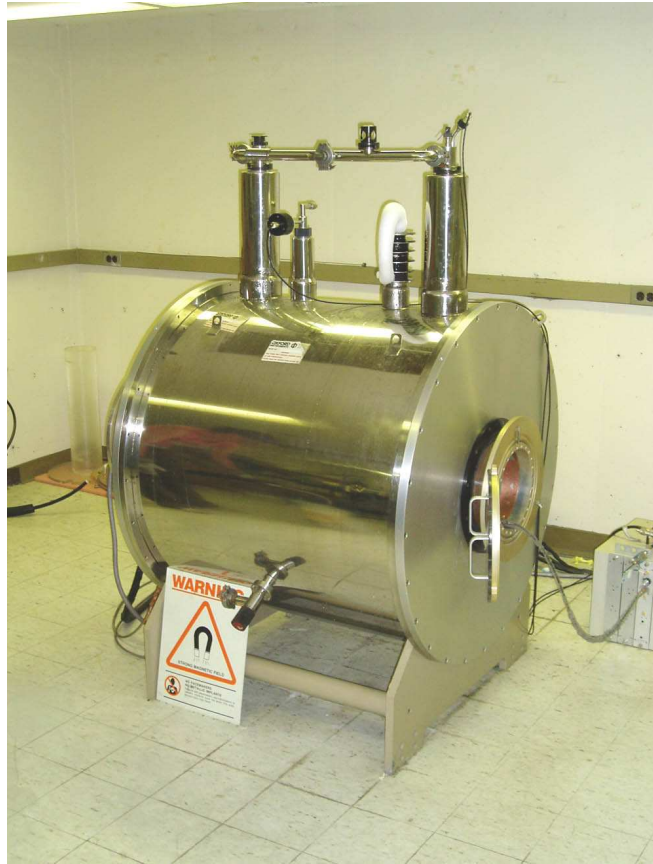
Abbildung 4: 2 Tesla Omega CSI-II Magnet (Brucker Instruments, Fremont, CA) mit selbstabschirmenden Acustar S-150 Gradientenspulen
