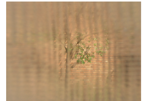
Abb.5-31: Visuelle Auswirkung von TWD-Strukturen bei einem Abstand von 30 cm vor dem Fenster
