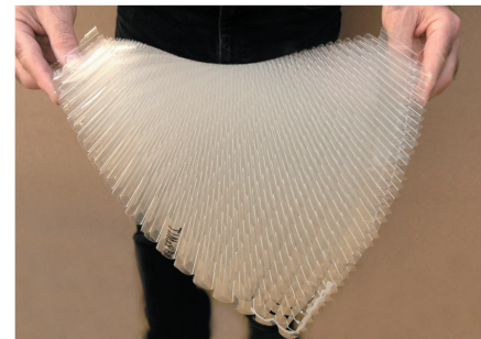
Abb.5-28: Verformungsmöglichkeiten der Wabenstrukturen aus Kunststofffolien unter verschiedenen Kräften.
