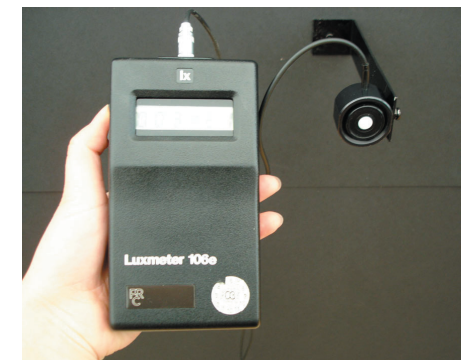
Abb. 6-10: Luxmeter zur Messung der Beleuchtungsstärke
