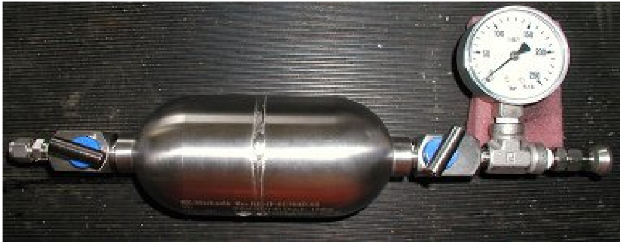
Abbildung 42: Behältersystem für Druck und Flüssig-CO 2 (Foto)
