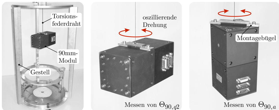
Bild 6.4: Ermittlung der Massenträgheitsmomente durch Auspendeln am Beispiel eines der 90mm-Module
