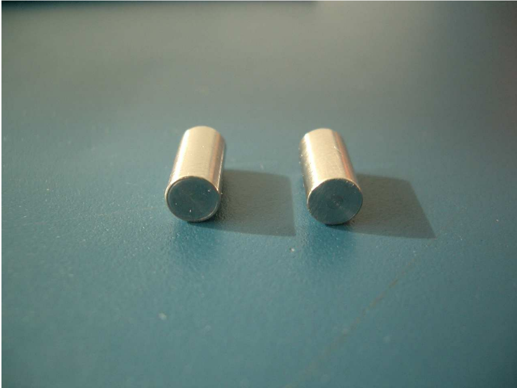
Abbildung 2.3: Fertig bearbeitete Proben für den Einsatz im Modellversuch (Dilatometerproben).
