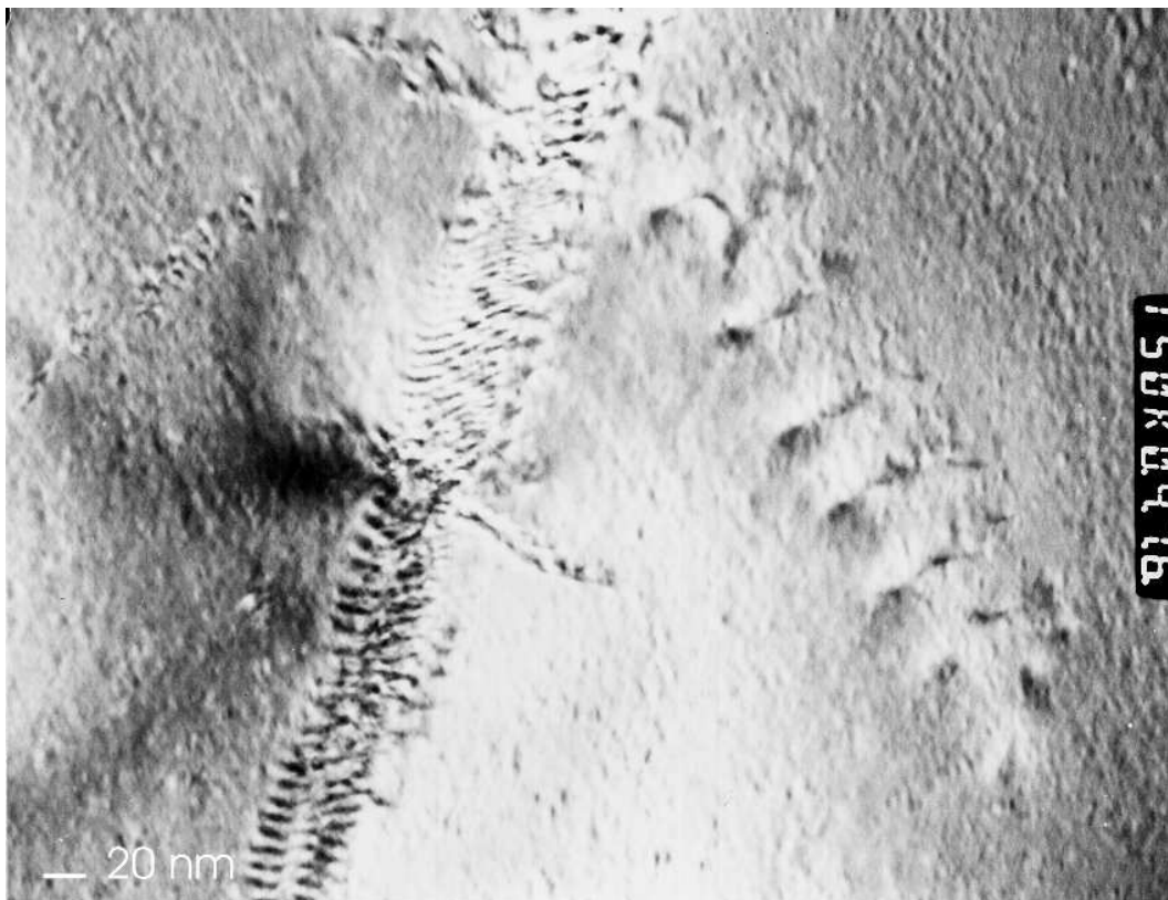
Abbildung 4.9: In Gleitbändern angeordnete Versetzungen in einer Scheibe der Serie B.
