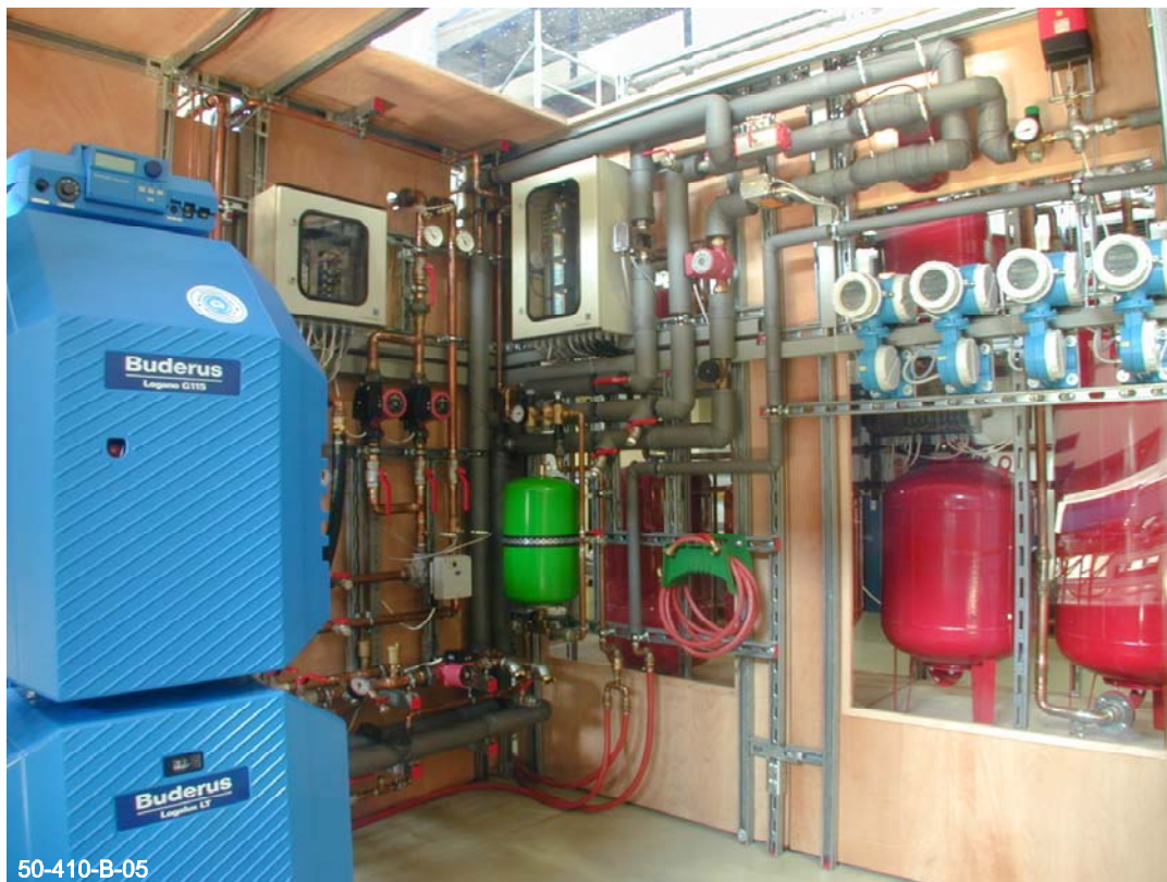
Abbildung 11-3: Wärmeerzeugerprüfstand am Lehrstuhl für Energiewirtschaft und Anwendungstechnik (TU München)
