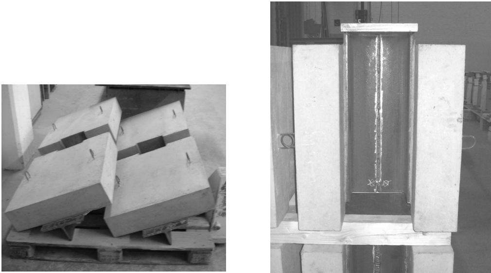
Abbildung 3.8: Ausgeschaltete Versuchskörperhälften (links) und Versuchskörper nach dem Zusammenschweißen der beiden Hälften (rechts)
