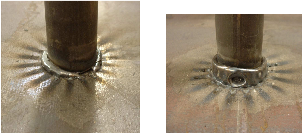
Abbildung 2.12: Zufällig verteilte Fehler im Schweißwulst infolge Blaswirkung
