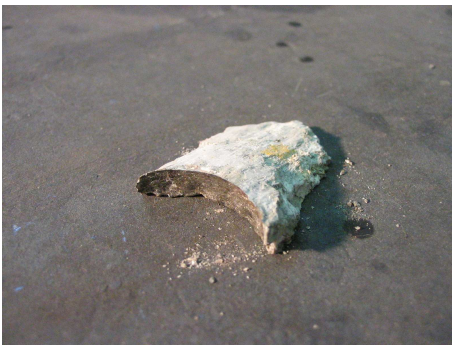
Abbildung 3.47: Gurt KI3.3.2 – Betonausbruch vor dem Fuß Dübel 1
