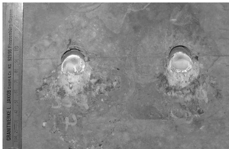
Abbildung 3.64: Betonausbruch unterhalb der Kopfbolzen mit abgedrehtem Schweißwulst , Zielbetonfestigkeitsklasse C35/45
