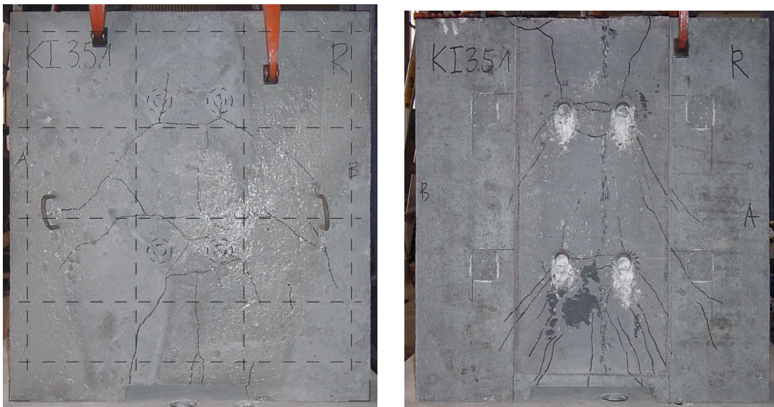
Abbildung 3.40: Gurt KI3.5.1 – Rissbild nach dem Bruchversuch
