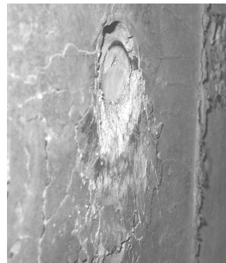
Abbildung 3.64: Betonausbruch unterhalb der Kopfbolzen mit abgedrehtem Schweißwulst , Zielbetonfestigkeitsklasse C35/45
