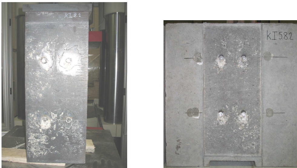
Abbildung 3.45: Gurt KI5.8.2 – Kontaktfläche Stahl/Beton nach dem Bruchversuch links: Stahlgurt mit anhaftendem Material rechts: Betongurt
