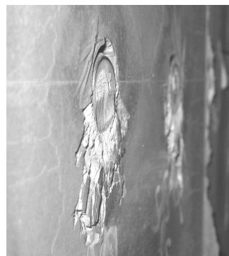
Abbildung 3.65: Betonausbruch unterhalb der Kopfbolzen mit abgedrehtem Schweißwulst , Zielbetonfestigkeitsklasse C90/105
