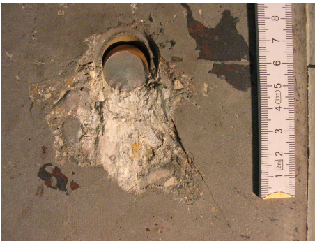
Abbildung 3.46: Gurt KI3.3.2 – Betonausbruch vor dem Fuß Dübel 1
