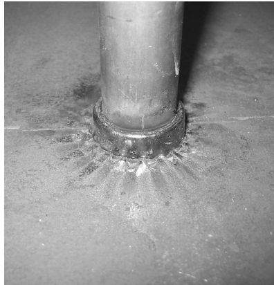
Abbildung 4.9: Oberer Rand des Schweißwulstes ohne Verbindung zum Dübelschaft
