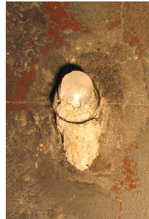
Abbildung 3.46: Gurt KI3.3.2 – Betonausbruch vor dem Fuß Dübel 1
