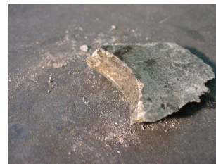
Abbildung 3.47: Gurt KI3.3.2 – Betonausbruch vor dem Fuß Dübel 1
