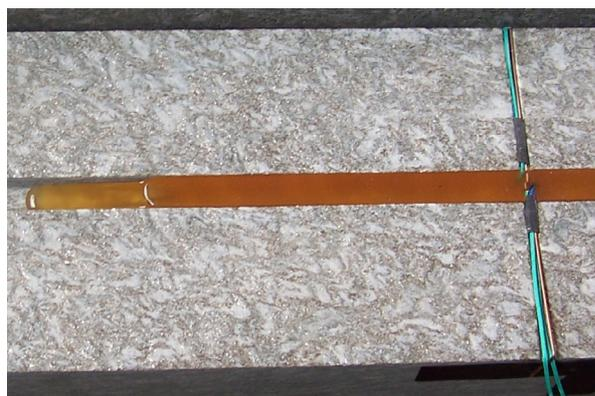
**Bild 6.7:** vollgefüllter Injektionskanal mit zungenförmiger Ausbildung der Injektionsfront
