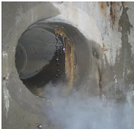
**Bild 6.25:** Austritt der Injektionsschmelze und Wasserdampfbildung infolge Kontakts mit Wasser
