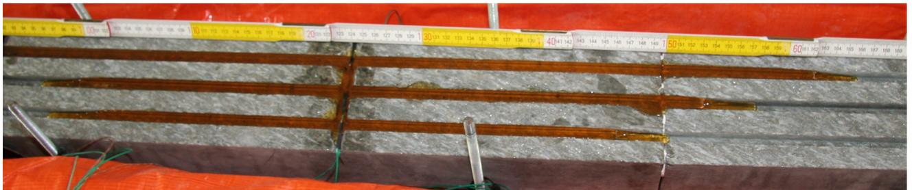
Injektionskörper Versuch V22: Verzweigung nach 1,25 m, Reichweite  $\pm 0,25$  m ... 0,35 m
