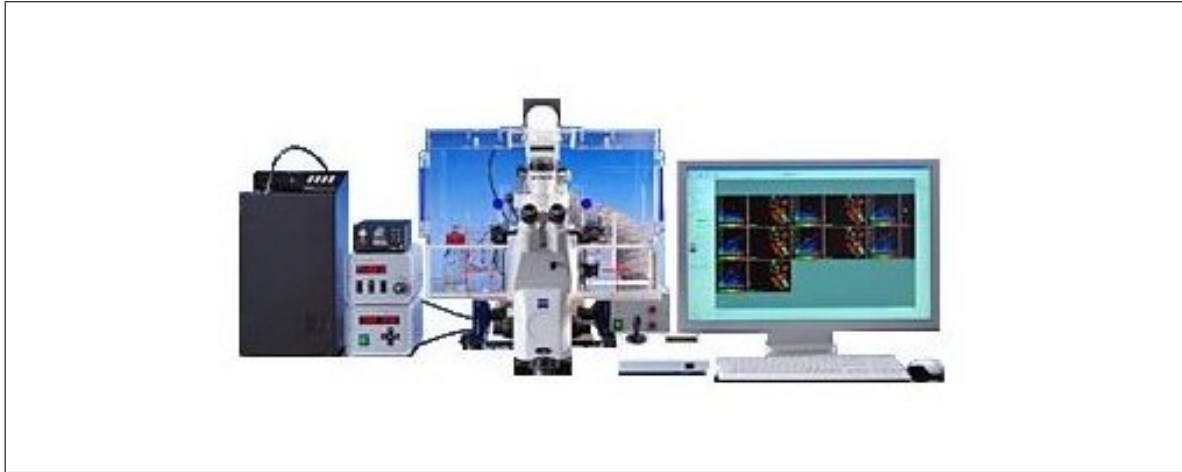
Abbildung 2.1: Live Cell Imaging-System Cell Observer von Carl Zeiss. Quelle: Carl Zeiss Internetauftritt: www.zeiss.de
