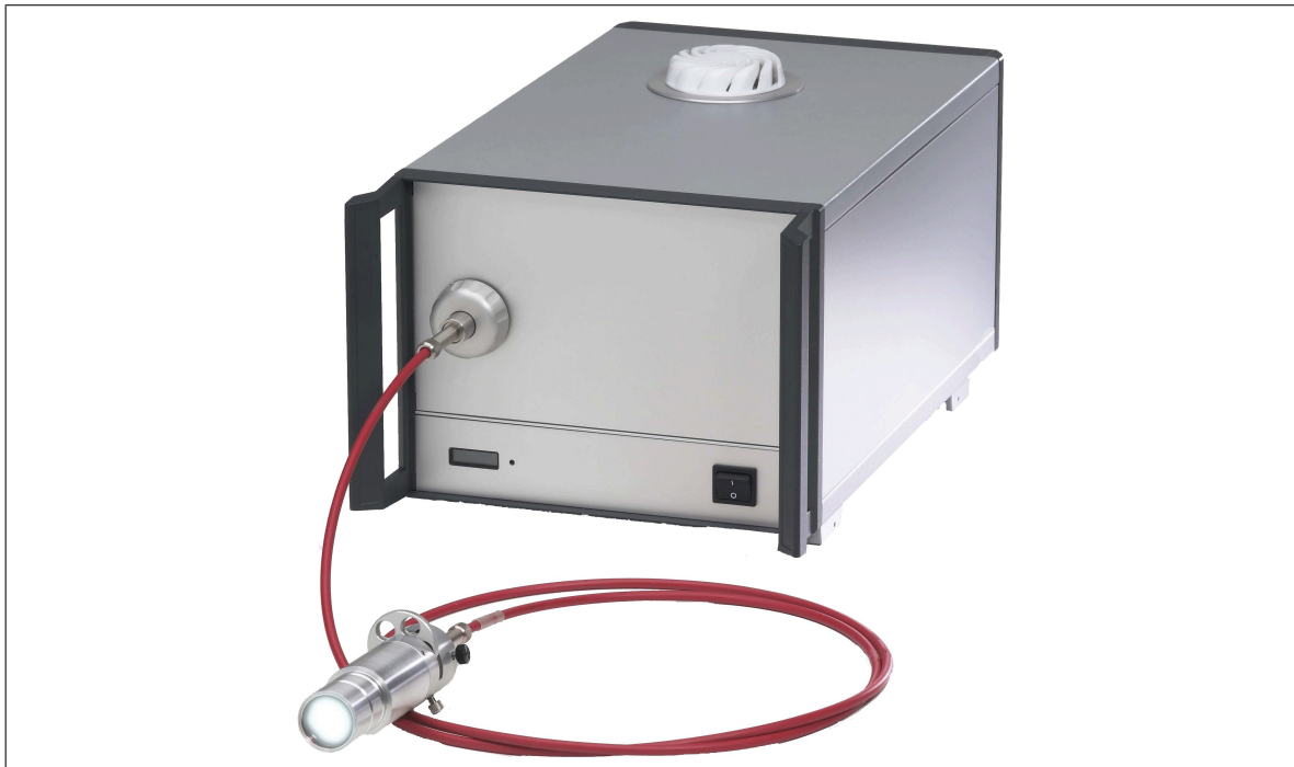
Abbildung 1.6: Polychrome V - Lichtquelle für Fluoreszenzmikroskopie (TILL Photonics): Stufenloses, programmierbares Einstellen der Wellenlänge des zur Anregung von Fluoreszenz benötigten Lichtes (320 nm bis 680 nm).
