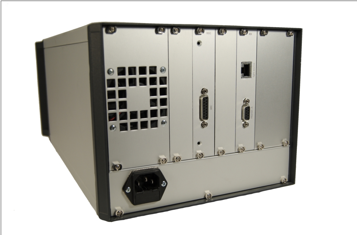
Abbildung 4.16: Rückansicht der ICU mit Lüftungsgitter und Steckverbindern zum Anschluss der Versorgungsspannung, der Verbindung zum Benutzer-PC, des Polychrome V und des iMIC.
