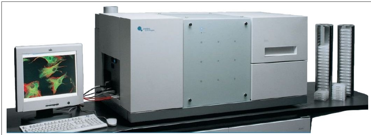
Abbildung 2.7: Konfokaler Mikrotiterplatten Reader Opera der Firma Evotec Technologies. Quelle: Evotec Technologies Internetauftritt: www.evotec-technologies.com
