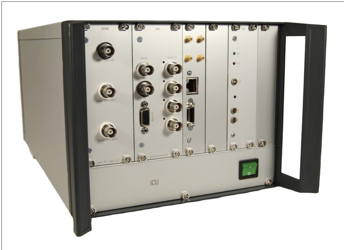
Abbildung 4.15: Ansicht der ICU-Vorderseite mit Hauptplatinen Einschub, Nebenplatinen Einschub „Multi-I/O“, Nebenplatinen Einschub „DSC“ und Sondereinschub „Piezo Control“
