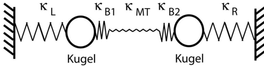
Abbildung 2.4: Mechanische Elemente der Dreikugelmethode: Die Federhärte des Gesamtsystems setzt sich aus den Federhärten der beiden Fallen \kappa_L und \kappa_R , der Federhärte des eingespannten Mikrotubulus \kappa_{MT} und den Federhärten der beiden Mikrotubuli/Kugel Bindungen \kappa_{B1} und \kappa_{B2} zusammen.
