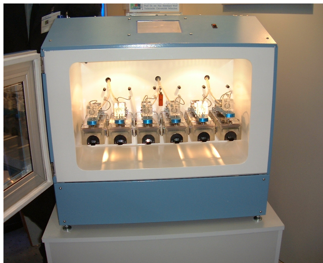
Abbildung 3.9: Sechsfach-Tester „TUM-Screen“ für Silizium-Sensorchips
