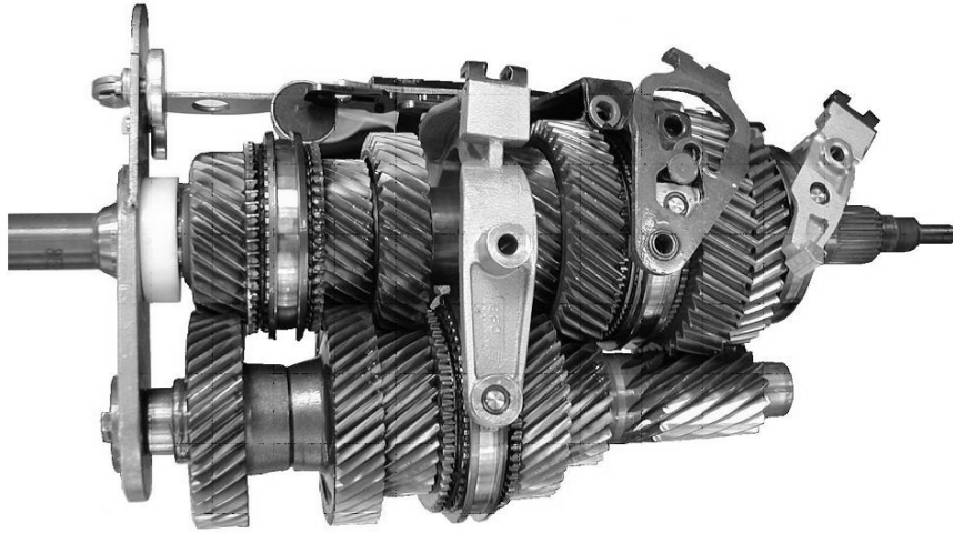
Abbildung 4.4: Das Innenleben des Handschaltgetriebes des BMW 545i.
