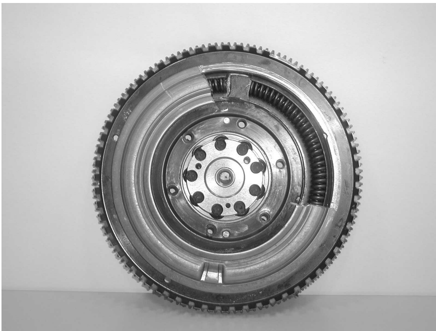
Abbildung 4.6: Diese Abbildung gewährt einen Blick auf das Innere eines Zweimassenschwungrades. Primär- und Sekundärseite sind voneinander getrennt, man blickt auf die Primärseite. Deutlich erkennbar sind Bogenfeder und Anlasserzahnkranz.
