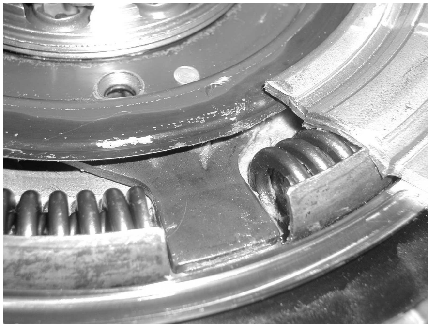
Abbildung 4.7: Auf der Detailabbildung eines Zweimassenschwungrades sind zwei Enden der beiden Bogenfedern, sowie zwei Enden der Bogenfederschalen gut sichtbar. Zwischen den beiden Bogenfedern befindet sich eine Zunge der Sekundärseite. Diese Zunge formt auf jeder Seite einen Anschlag für eine der beiden Bogenfedern.
